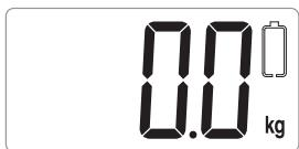
Si la batterie est trop faible pour effectuer la pesée, l'indication ci-contre apparaît à l'écran et l'écran s'éteint automatiquement après quelques secondes. Il vous suffit alors d'appuyer de nouveau sur le bouton de mise en marche central « POWER ».
