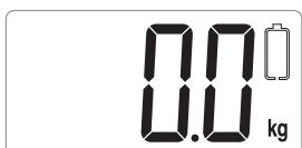
Wenn der Akku zu schwach ist, um den Wiegevorgang durchzuführen, erscheint auf dem Display die nebenstehende Anzeige und das Display schaltet sich nach einigen Sekunden automatisch aus.
