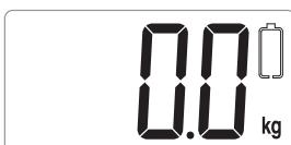
Si la batería está demasiado baja para realizar la medición del peso, aparece en la pantalla la indicación contigua y la pantalla se apaga automáticamente después de unos segundos.
