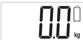
Als de batterij niet genoeg geladen is om de weging uit te voeren, wordt de onderstaande indicatie op het scherm weergegeven en gaat het scherm na enkele seconden automatisch uit.
