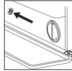
Retirer le bouchon du « tuyau d'évacuation d'urgence » de l'extrémité du tuyau et laisser l'eau s'écouler dans le récipient.
