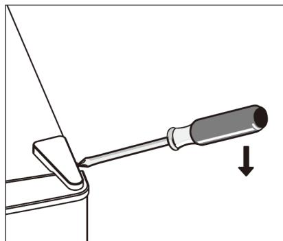
2. Lösen Sie die Schrauben und entfernen Sie die Scharnierhalterung.
