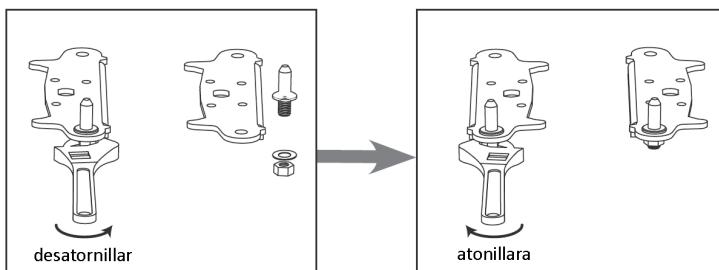
6. Vuelva a ajustar el soporte fijándolo al pasador de la bisagra inferior. Vuelva a colocar las dos patas ajustables.
