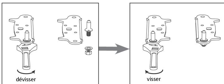
6. Remontez la fixation du support sur l'axe de la charnière inférieure. Remettez en place les deux pieds réglables.
