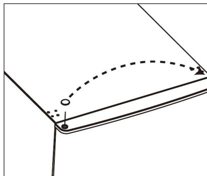
5. Desatornille y retire el pasador de la bisagra inferior, gire el soporte y vuelva a colocarlo.
