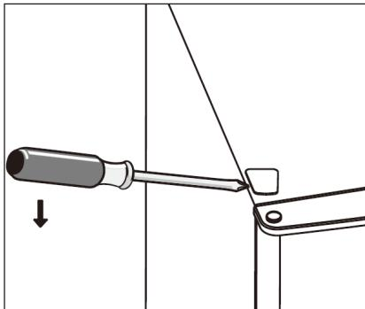
4. Verplaats het deksel in het midden van de linkerzijde naar de rechterzijde. Til de bovenste deur omhoog en plaats ze op een zacht oppervlak om krassen te vermijden.
