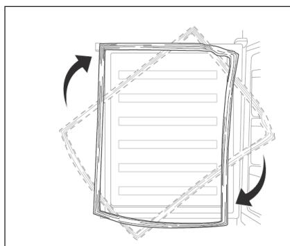
8. Retirez les douilles de fermeture au bas des portes, puis prenez le nouvelles douilles de fermeture du sachet d'accessoires et installez-les à gauche
