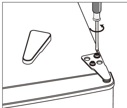
3. Entfernen Sie die Abdeckung der oberen linken Schraube.
