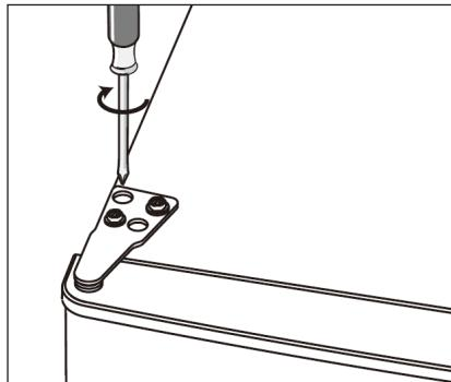
12. Remettez les caches charnière et vis en place. Une fois les portes fermées, vérifiez qu'elles sont alignées horizontalement et verticalement et que les joints sont bien fermés sur tous les côtés avant de resserrer la charnière du bas. Ré-ajustez les pieds de mise à niveau si nécessaire.
