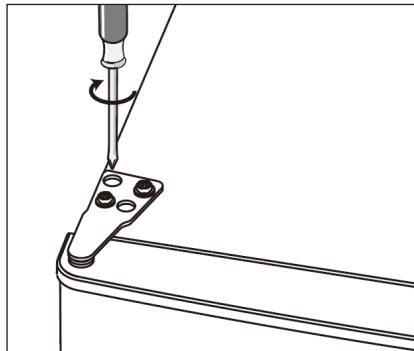
12. Plaats het scharnierdeksel en het schroefdeksel opnieuw op hun plaats. Controleer met de deuren gesloten of de deuren horizontaal en verticaal afgelijnd zijn en of de dichtingen aan alle zijden gesloten zijn alvorens de onderste scharnier definitief vast te draaien. Pas de verstelvoetjes indien nodig aan.
