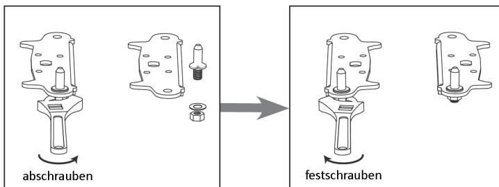
6. Den Beschlag der Halterung wieder am Stift des unteren Scharniers anbringen. Die beiden Stellfüße wieder montieren.
