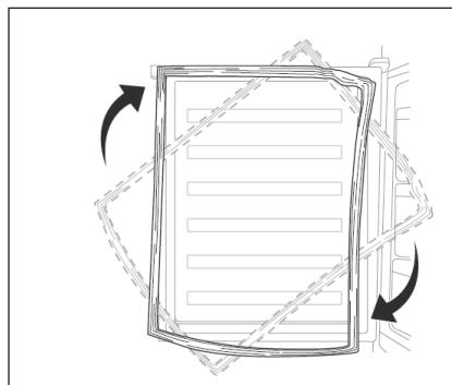
8. Retire los cierres auxiliares de la parte inferior de las puertas, coja cierres auxiliares nuevos de la bolsa de accesorios e instálelos en el lado izquierdo
