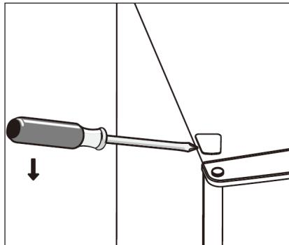
4. Versetzen Sie die Abdeckung von der linken Seite auf die rechte Seite. Dann die obere Tür anheben und abnehmen und auf eine gepolsterte Unterlage legen, um Kratzer zu vermeiden.
