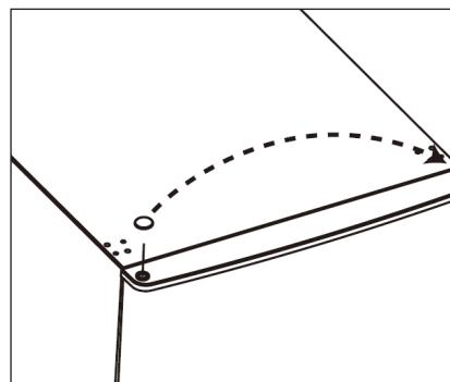
5. Den Stift des unteren Scharniers abschrauben und entfernen, dann die Halterung umdrehen und wieder anbringen.
