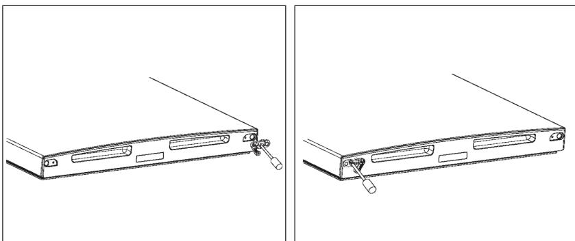
9. Plaats de bovenste deur opnieuw. Zorg ervoor dat de deur horizontaal en verticaal afgelijnd is zodat de dichtingen aan alle zijden gesloten zijn alvorens het bovenste scharnier vast te draaien.
