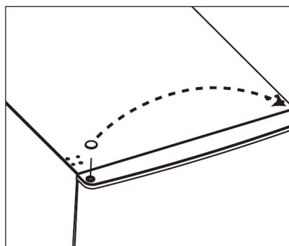
5. Schroef de pin van het onderste scharnier los, verwijder ze, draai het haakje om en plaats het opnieuw.
