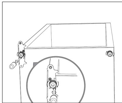
7. Lösen Sie die Türdichtung, drehen Sie sie um 180° und bringen Sie sie dann wieder an.
