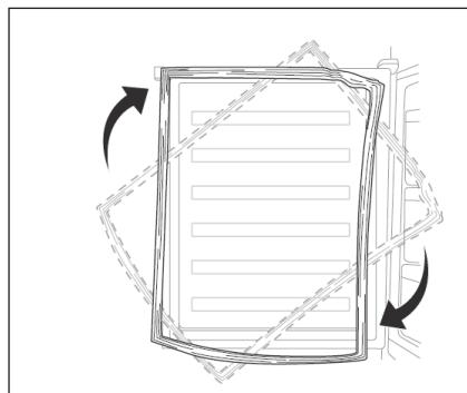
8. Verwijder de hulpsluiters van de onderkant van de deur, neem nieuwe hulpsluiters uit het zakje met accessoires en installeer ze aan de linkerzijde
