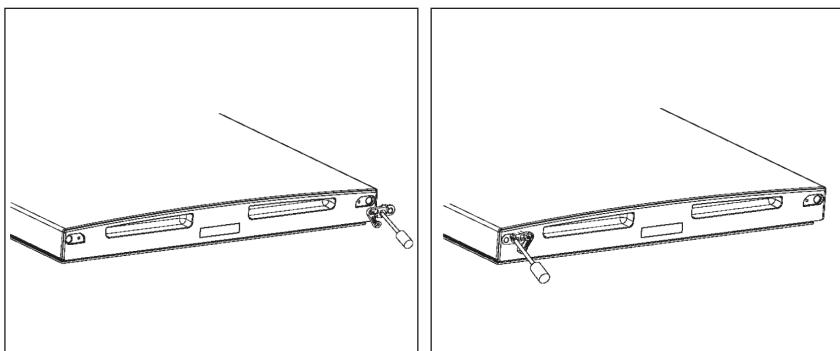
9. Die obere Tür wieder anbringen. Vor dem Festziehen des oberen Scharniers überprüfen, ob die Tür horizontal und vertikal so ausgerichtet ist, dass die Dichtungen auf allen Seiten geschlossen sind.
