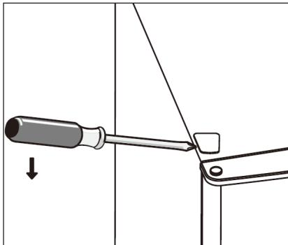
4. Mueva la tapa del centro de izquierda a derecha. Luego, levante la puerta superior y apóyela sobre una superficie acolchada para evitar rayarla.
