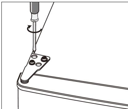
12. Vuelva a colocar la tapa de la bisagra y la tapa del tornillo. Con las puertas cerradas, compruebe que las puertas estén alineadas horizontal y verticalmente y que las juntas estén cerradas por todos sitios antes de ajustar finalmente la bisagra inferior. Vuelva a ajustar las patas de nivelación en caso necesario.
