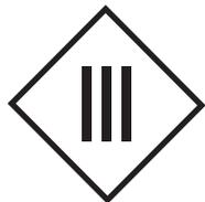
Dieses Symbol bedeutet, dass es sich bei dem Produkt um ein Gerät handelt, das der Isolationsklasse III angehört. Dieses Produkt der Klasse III muss von einem Transformator gespeist werden, der mit einer Sicherheits-Kleinspannung betrieben wird.
