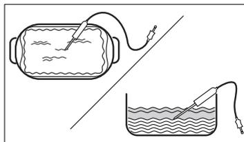
**Stap 4** Steek de Voedselsensor in de aansluiting op de voorkant van de oven. Het display toont de huidige temperatuur van: Voedselsensor.
