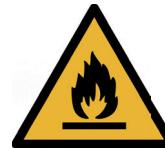
Este símbolo indica que este aparato utiliza un refrigerante inflamable. Si el refrigerante tiene una fuga y se expone a una fuente de ignición externa, existe riesgo de incendio.
