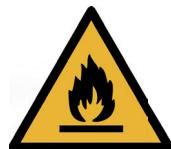
Ce symbole indique que cet appareil utilise un réfrigérant inflammable. Si le réfrigérant a fui et est exposé à une source d'allumage externe, il y a un risque d'incendie.
