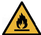
Dit symbool geeft aan dat dit apparaat een ontvlambaar koelmiddel gebruikt. Als het koelmiddel heeft gelekt en wordt blootgesteld aan een externe ontstekingsbron, bestaat er brandgevaar.
