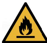
Dieses Symbol weist darauf hin, dass dieses Gerät ein brennbares Kältemittel verwendet. Wenn das Kältemittel ausgetreten ist und einer externen Zündquelle ausgesetzt wird, besteht Brandgefahr.
