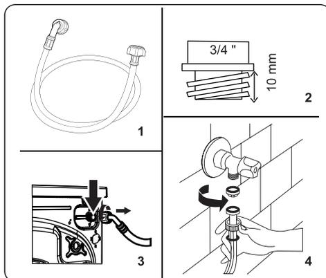
1. En fonction de ses caractéristiques techniques, votre machine peut être équipée soit d'un seul et unique raccord de tuyau d'arrivée d'eau (eau froide), soit d'un raccord double (eau chaude et eau froide). Le tuyau à bouchon blanc doit être raccordé à l'arrivée d'eau froide et celui à bouchon rouge à l'arrivée d'eau chaude (le cas échéant).
