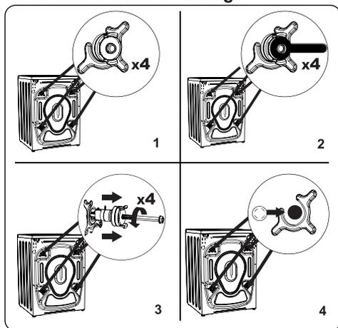
1. Avant d'utiliser le lave-linge, retirer les 4 vis de bridage et rondelles en caoutchouc situées à l'arrière de la machine. Le non-respect de cette consigne peut causer de fortes vibrations, un niveau de bruit important et détériorer de la machine et rendre la garantie caduque.
