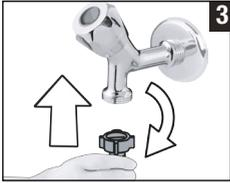
**3** Nach dem Anschluss der Schläuche öffnen Sie die Wasserzuläufe (Hähne) komplett; überzeugen Sie sich davon, dass kein Wasser an den Anschlussstellen austritt.
