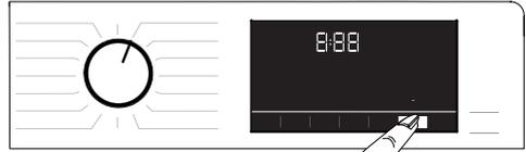
Mit der **Endzeit**-Funktion können Sie den Beginn des Waschvorgangs um bis zu 24 Stunden hinausschieben. Nach Betätigen der **Endzeit**-Taste entspricht die angezeigte Zeit der geschätzten Endzeit des Programms. Falls eine **Endzeit** eingestellt ist, leuchtet die Endzeit-Anzeige auf.
