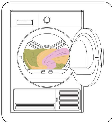
**⚠ IMPORTANT :** Il n'est pas recommandé de charger le Sèche-linge avec une quantité de linge supérieure à celle indiquée sur la figure. Lorsqu'il est surchargé, sa performance de séchage diminue, ce qui peut causer des dommages au le Sèche-linge et au linge.
