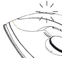
Wenn sich das Bügeleisen aufheizt, leuchtet die Kontrollleuchte des Thermostats. Die Kontrollleuchte erlischt, wenn das Bügeleisen die gewählte Temperatur erreicht hat. Die Kontrollleuchte leuchtet auf und erlischt abwechselnd während des Betriebs. Sie reguliert die gewählte Temperatur. Das ist normal.
