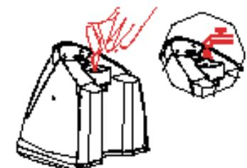
Remplissez le réservoir d'eau du robinet via l'orifice de remplissage en le plaçant sous un robinet.
