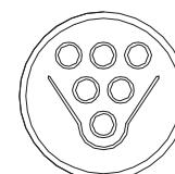
Um die Lebensdauer Ihrer Dampfbügelstation zu verlängern und die Kalkbildung einzuschränken, sollte eine Selbstreinigung des Geräts durchgeführt werden, wenn das Symbol aufleuchtet.
