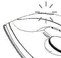
Lorsque le fer chauffe, le voyant du thermostat est allumé. Le voyant s'éteint lorsque le fer atteint la température sélectionnée. Le voyant s'allume et s'éteint lors de l'utilisation ; il régule la température sélectionnée. Ceci est normal.
