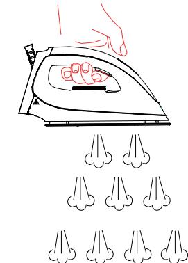
7. Druk tweemaal op de stoomknop om een gerichte afgifte van de stoom te verkrijgen, met name om een kruiksel te verwijderen of een sterk gekruikelde zone glad te strijken.
