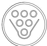
Om de levensduur van uw stoomgenerator te verlengen en kalkvorming te beperken, moet u de zelfreiniging uitvoeren wanneer het symbool gaat branden.
