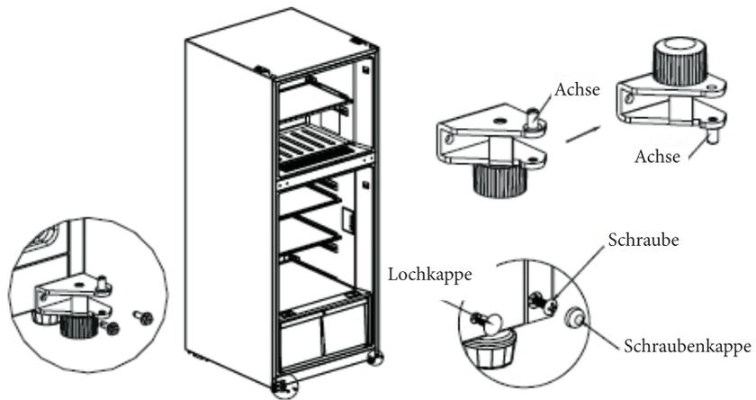
5) Demontieren Sie die Stopper und Hülsenrohre der Kühl- und Gefrierschranktür und bringen Sie sie auf der anderen Seite der beiden Türen an. Tauschen Sie die Installationsposition des Hülsenrohrs und der Lochkappe an der oberen Endkappe der Kühlschranktür aus. Entfernen Sie die linke Zierabdeckung der Gefrierschranktür, und verschieben Sie das Hülsenrohr
