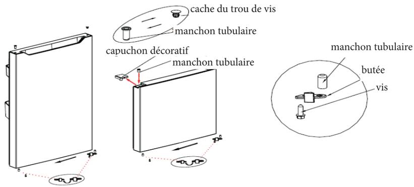
6) Installez la porte du compartiment de réfrigération sur la charnière inférieure puis installez la charnière centrale, les vis et les caches.
