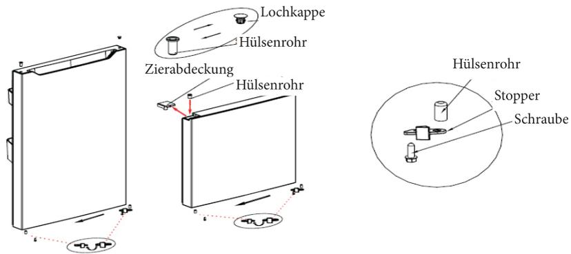
6) Setzen Sie die Kühlfachtür auf das untere Scharnier, montieren Sie anschließend das mittlere Scharnier, die Schrauben und die Kappen.
