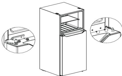
7) Entnehmen Sie das linke obere Scharnier, die linke obere Scharnierabdeckung und die rechte Zierabdeckung aus dem Zubehörbeutel, setzen Sie die Gefrierschranktür auf das mittlere Scharnier und installieren Sie das linke obere Scharnier, die linke Scharnierabdeckung und die Lochkappe. Bringen Sie schließlich die rechte Zierabdeckung an der rechten Seite der Endkappe der Gefrierschranktür an.
