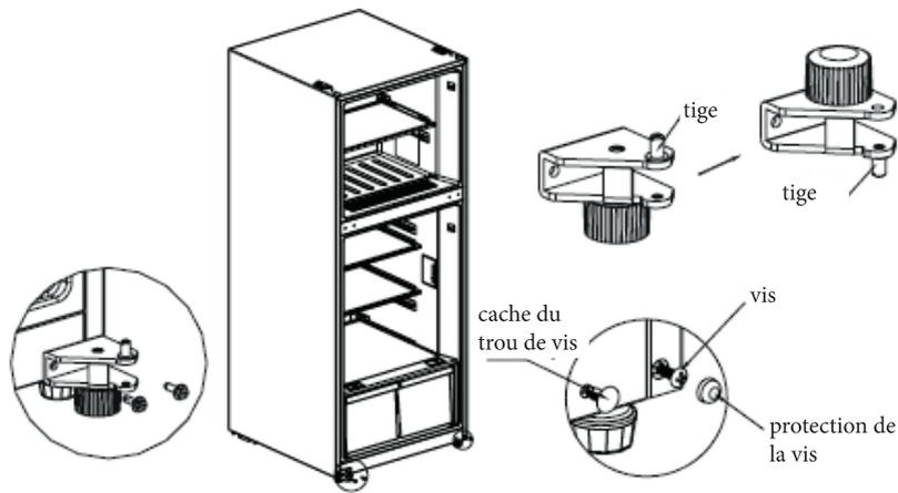
5) Démontez les butées, les manchons tubulaires des deux portes et installez-les de l'autre côté de chaque porte ; échangez le positionnement du manchon et du cache-trou sur la partie supérieure de la porte du réfrigérateur ; Enlevez le capuchon décoratif gauche de la porte du congélateur et décalez le manchon
