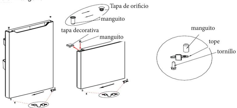
6) Instala la puerta del frigorífico en la bisagra inferior y, a continuación, instala la bisagra central, los tornillos y las tapas.
