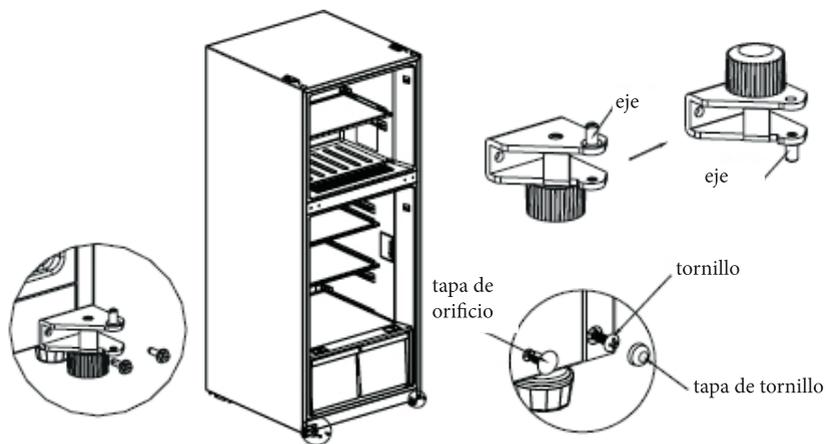
5) Desmonta los topes y los manguitos de las puertas del congelador y del frigorífico; procede a instalarlas en el otro lado de ambas puertas; intercambia la posición de instalación del manguito y la tapa de orificio en la tapa del extremo superior de la puerta del frigorífico; retira la tapa decorativa izquierda de la puerta del congelador y mueve el manguito
