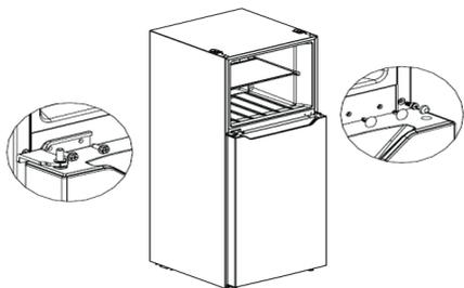
7) Extrae la bisagra superior izquierda, la tapa de la bisagra superior izquierda y la tapa decorativa derecha de la bolsa de accesorios, coloca la puerta del congelador en la bisagra central y coloca la bisagra superior izquierda, la tapa de la bisagra izquierda y la tapa de orificio. Por último, coloca la tapa decorativa derecha en el lado derecho de la tapa de extremo en la puerta del congelador.
