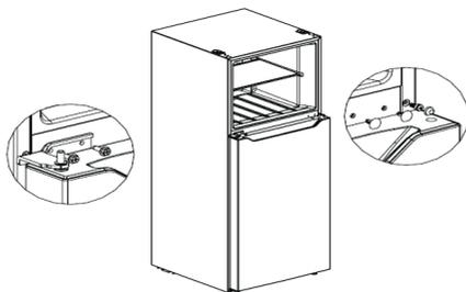
7) Neem het bovenste scharnier links, het deksel van het bovenste scharnier links en het sierdeksel rechts uit het zakje met accessoires, installeer de diepvriezerdeur op het middelste scharnier en installeer het bovenste scharnier links het deksel van het scharnier links en het gatdeksel. Installeer tot slot het sierdeksel rechts op de rechterzijde van de diepvriezerdeur.
