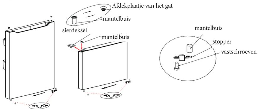
6) Installeer de deur van het koelcompartiment op het onderste scharnier en installeer vervolgens het middelste scharnier, de schroeven en de deksels.
