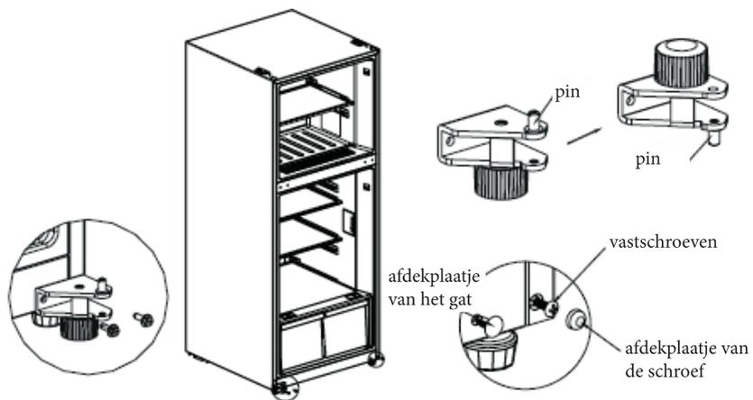
5) Demonteer de stoppers, de mantelbuizen en de deuren van zowel de koelkast als de diepvriezer en monteer ze op de andere zijde van beide deuren; verwissel de installatiepositie van de mantelbuis en gatdeksel op het bovenste einddeksel van de koelkastdeur; verwijder het sierdeksel links van de diepvriezerdeur en verplaats de mantelbuis
