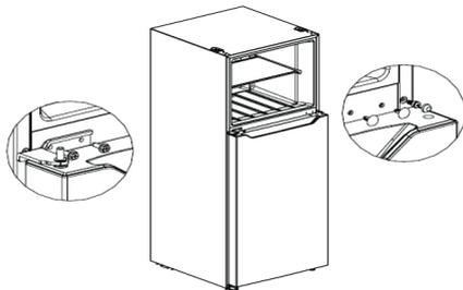
7) Récupérez la charnière supérieure gauche, le cache de la charnière supérieure gauche et le couvercle décoratif dans le sac d'accessoires, installez la porte du congélateur sur la charnière centrale, puis installez la charnière supérieure gauche, le cache de la charnière de gauche et le cache-trou. Enfin, installez le capuchon décoratif droit sur le côté droit de la porte du congélateur.
