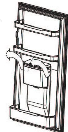
2. Verwijder de kop en de dichting van het reservoir
