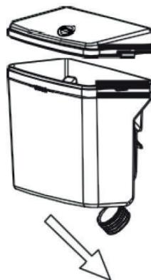
3. Separe la junta de estanqueidad del cabezal del depósito
