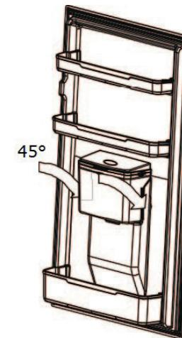
3. Séparez le joint d'étanchéité de la tête du réservoir
