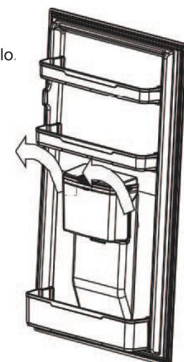
2. Retire el cabezal y su junta de estanqueidad del depósito
