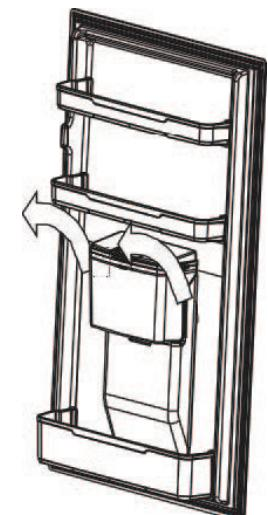
2. Retirez la tête et son joint d'étanchéité du réservoir
