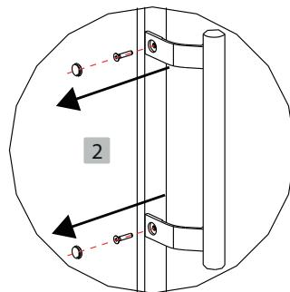
2. Demonteer de handgreep van de deur: verwijder de afdekplaatjes, draai de schroeven los en verwijder de handgreep.
