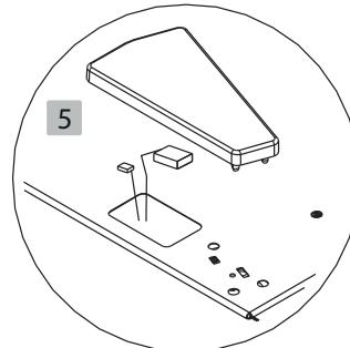
7. Désinstallez le mécanisme situé au bas de l'appareil : retirez la tige, le pied réglable ainsi que la charnière.
