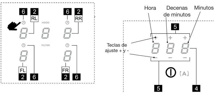
**Observación:** Espere 10 segundos sin presionar ningún otro control para iniciar el temporizador de una zona de cocción.
