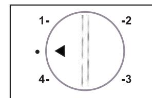
Para optimizar la conservación de los alimentos, ponga el termostato en «2». Este ajuste garantiza la conservación correcta de los alimentos congelados y el mantenimiento de una temperatura de -18 °C en el congelador.
