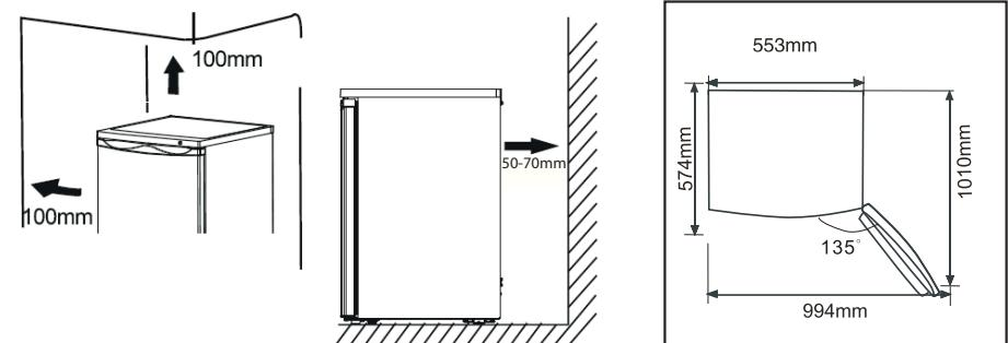
Achten Sie darauf, dass die Luft immer frei um das Gerät herum zirkulieren kann. Zwischen der Oberseite des Gehäuses und darüber angebrachter Kücheneinrichtung muss ein Abstand von mindestens 100 mm und auf beiden Seiten des Geräts ein Abstand von 100 mm vorhanden sein. Lassen Sie einen Abstand von mindestens 75 mm zwischen der Geräterückseite und der Wand.
