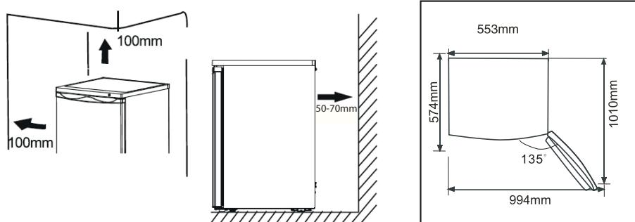
Asegúrese de que el aire siempre pueda circular libremente alrededor del aparato. Debe haber por lo menos 100 mm entre la parte superior del aparato y cualquier equipo de cocina instalado sobre él y un espacio de 100 mm a cada lado. Deje un espacio de al menos 75 mm entre la pared trasera del aparato y la pared.
