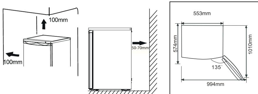
Veillez à ce que l'air puisse toujours circuler librement autour de l'appareil. Il doit y avoir au minimum 100 mm entre le dessus de la caisse et tout équipement de cuisine fixé au-dessus, et un espace de 100 mm de chaque côté de l'appareil. Laissez un espace d'au moins 75 mm entre l'arrière de l'appareil et le mur.
