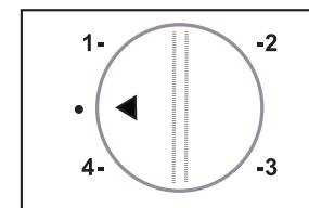
**Um die Haltbarkeit Ihrer Lebensmittel zu optimieren, stellen Sie den Thermostat auf „2“. Diese Einstellung stellt sicher, dass Tiefkühlkost korrekt gelagert wird und im Gefrierfach eine Temperatur von -18° C eingehalten wird.**
