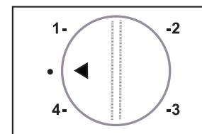
**Om de bewaring van uw voedsel te optimaliseren, zet u de thermostaat op 2". Deze instelling zorgt ervoor dat diepvriesproducten op de juiste manier worden bewaard en dat een temperatuur van -18 °C in de diepvriezer wordt gehandhaafd.**
