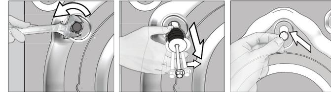
**IMPORTANTE:** los tornillos de sujeción que sirven para prevenir cualquier daño interno durante el transporte, ¡deben retirarse antes de poner en funcionamiento la lavadora! De lo contrario, el aparato se dañará y no estará cubierto por la garantía.
