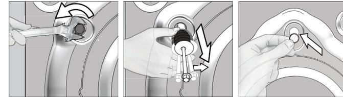
**BELANGRIJK:** de transportschroeven die dienen om elke interne beschadiging tijdens het transport te voorkomen, moeten worden verwijderd alvorens de wasmachine aan te zetten! Zo niet zal het toestel beschadigd raken en dit is niet gedekt door de garantie.
