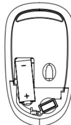
3. Nehmen Sie den Nano-Empfänger aus dem Fach. Setzen Sie den Deckel wieder auf.
