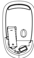
3. Haal de nano-USB-ontvanger uit het vak. Breng het klepje daarna weer aan.
