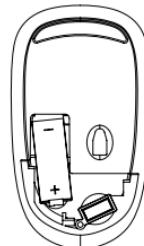
3. Retire el nanorreceptor del compartimento. Finalmente, vuelva a colocar la tapa.
