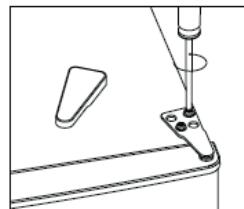
3. Con un destornillador plano, retire la tapa que cubre el hueco.
