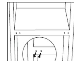
7. Leg de achterkant van de kast op een zacht oppervlak. Schroef de onderste scharnier en de verstelvoetjes los.
