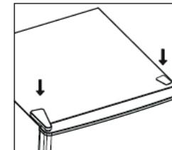
15. Die Türdichtungen des Kühlschranks und des Gefrierschranks lösen und nach dem Drehen wieder anbringen.
