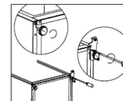
8. Schroef de pin van de onderste scharnier los, verwijder ze, draai het haakje om en plaats het opnieuw.
