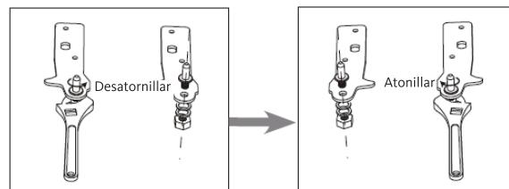
9. Instale la bisagra en el lado izquierdo y la base del pie en el lado derecho. Luego, atornille los dos pies de nivelación con sus piezas de origen.
