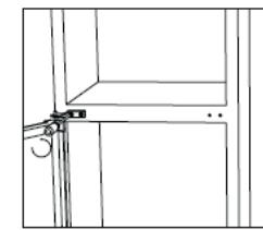
13. Die obere Tür mit dem oberen Scharnier installieren.
