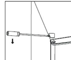
4. Die Abdeckung des Scharnierkerns von der linken auf die rechte Seite versetzen. Dann die untere Tür anheben und abnehmen und auf eine gepolsterte Unterlage legen, um Kratzer zu vermeiden.
