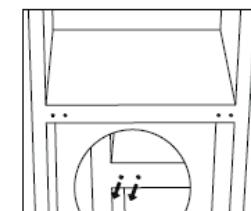
7. Posez l'arrière de l'appareil sur une surface rembourrée. Dévissez la charnière du bas et les pieds de mise à niveau.
