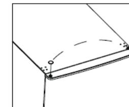
5. Schroef de middelste scharnier los en til de onderste deur omhoog en leg ze op een zacht oppervlak om krassen te vermijden.
