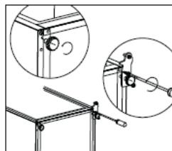
8. Den Stift des unteren Scharnier abschrauben und entfernen, dann die Halterung umdrehen und wieder anbringen.
