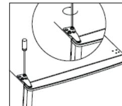
14. Die Scharnierabdeckung und die Lochabdeckung auf der Oberseite des Geräts anbringen.
