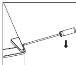
2. Das obere Scharnier mit einem Kreuzschlitzschraubenzieher abschrauben.
