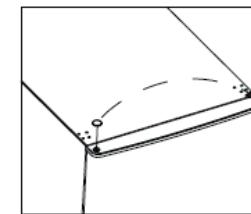
5. Destornille la bisagra intermedia, luego, levante la puerta inferior y apóyela sobre una superficie acolchada para evitar que se raye.
