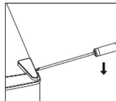
2. Schroef de bovenste scharnier los met een kruiskopschroevendraaier.
