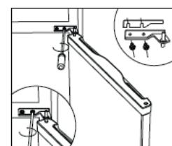
6. Die beiden mittleren Lochabdeckungen von links nach rechts versetzen.
