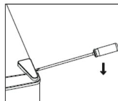
2. Con un destornillador cruciforme, destornille la bisagra superior.
