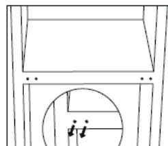
11. Zet de eenheid recht en plaats de deur op de onderste scharnier. Zorg ervoor dat de onderste scharnier in de opening onderaan de deur zit. Verplaats het afdekplaatje van de scharnier van de onderste deur van links naar rechts.
