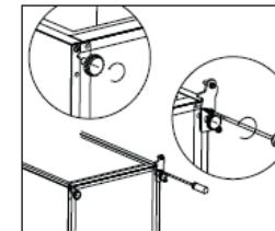
8. Destornille y retire el pasador de la bisagra inferior, gire el soporte y vuelva a colocarlo.
