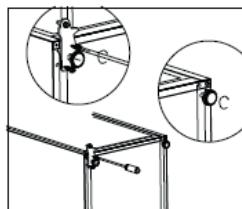
10. Die beiden mittleren Lochabdeckungen von links nach rechts versetzen.
