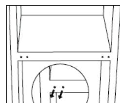
11. Levante la unidad y ponga la puerta en la bisagra superior. Asegúrese de que el centro de la bisagra inferior esté puesto en el agujero de la puerta. Luego, desplace la tapa del agujero de la bisagra de la puerta inferior del lado izquierdo al derecho.
