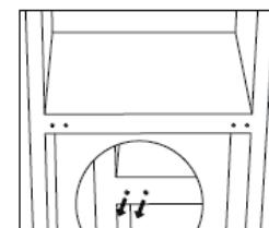
7. Die Rückseite des Gehäuses auf eine weiche Unterlage legen. Das untere Scharnier und den Stellfuß abschrauben.
