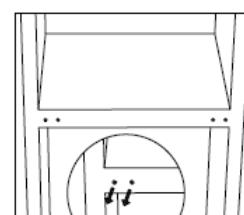
11. Remettez l'appareil debout et placez la porte sur la charnière du bas. Assurez-vous que le centre de la charnière du bas est inséré dans le trou de la porte. Puis déplacez le cache du trou de la charnière de la porte du bas de la gauche vers la droite.
