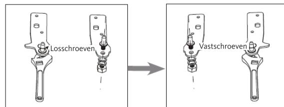
9. Monteer de scharnier aan de linkerkant en de voetbasis aan de rechterkant. Schroef de twee verstelvoetjes vast met hun originele onderdelen.
