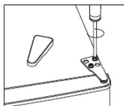
3. Die Lochabdeckung mit einem Schlitzschraubenzieher entfernen.
