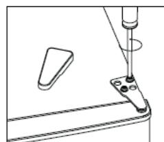
3. Verwijder het deksel van het gat met een platte schroevendraaier.
