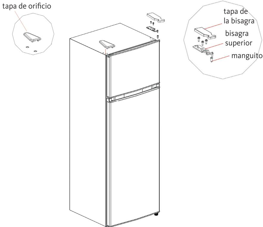
3. Retire la puerta del compartimento del congelador, la bisagra central, el manguito de la puerta del frigorífico y las tapas de orificio del otro lado.
