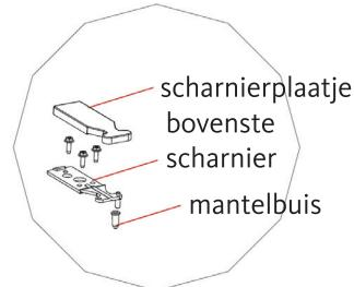
3. Verwijder de deur van het diepvriesvak, het middelste scharnier, de mantelbus van de koelkastdeur en de afdekplaatjes aan de andere kant.
