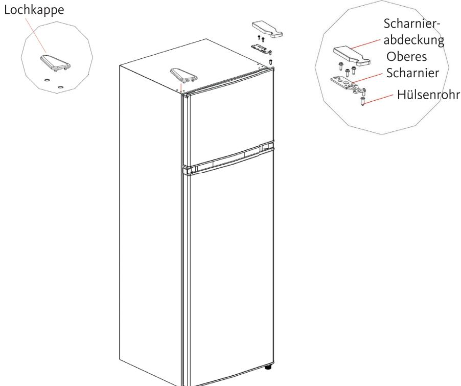
3. Die Tür des Gefrierabteils, das mittlere Scharnier, das Hülsenrohr der Tür des Kühlabteils und die Lochkappen auf der anderen Seite entfernen.
