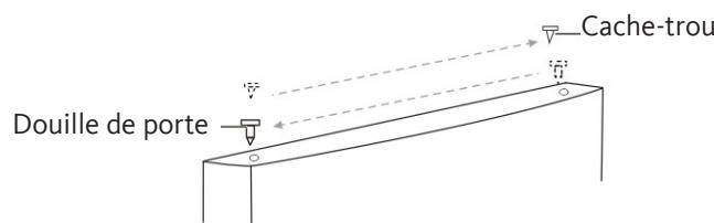
13. Retirez le cache-trou de la charnière centrale sur le côté gauche de l'appareil, puis insérez-le dans les trous de vis sur la droite de l'appareil.
