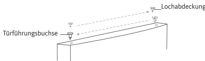
18. Entfernen Sie die Lochabdeckung an der oberen linken Seite des Schranks und befestigen Sie die Abdeckung an der oberen rechten Seite des Schranks.
