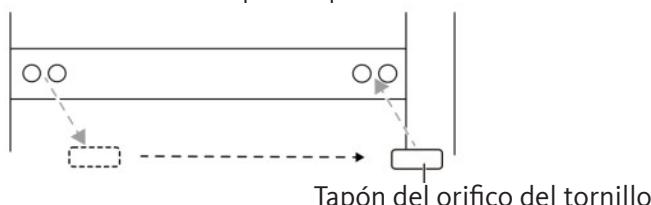
14. Instale la bisagra central en el lado izquierdo con los dos tornillos que retiró anteriormente.
