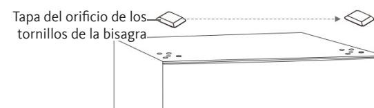
19. Fije la bisagra superior en el lado superior izquierdo del cuerpo del aparato con los tres tornillos que quitó anteriormente. Antes de apretar los tornillos de la bisagra superior, asegúrese de que la parte superior de la puerta está correctamente nivelada con el cuerpo del aparato y de que la junta de goma garantiza un buen sellado.
