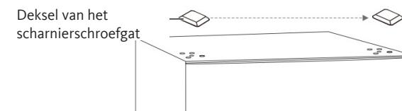
19. Maak het bovenste scharnier linksboven aan de kast vast met de drie schroeven die u eerder hebt verwijderd. Voor u de schroeven van het bovenste scharnier vastdraait, moet u ervoor zorgen dat de bovenkant van de deur waterpas staat met de kast en dat de rubberen packing goed afdicht.
