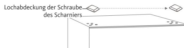
19. Das obere Scharnier mit den zuvor entfernten Schrauben an der oberen linken Seite des Schranks befestigen. Vor dem Anziehen der oberen Scharnierschrauben überprüfen, ob die Oberkante der Tür auf gleicher Höhe mit dem Schrank abschließt und ob die Gummidichtung ordnungsgemäß dicht schließt.
