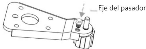
9. Instale la bisagra inferior en el lado izquierdo del cuerpo del aparato.
