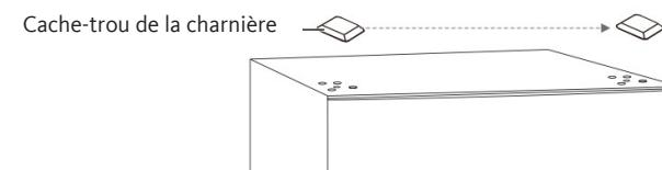
19. Fixez la charnière supérieure sur le côté supérieur gauche de l'appareil à l'aide des trois vis que vous avez retirées précédemment. Avant de serrer les vis de la charnière supérieure, assurez-vous que le haut de la porte est bien au même niveau que le corps de l'appareil et que le joint en caoutchouc est bien hermétique.
