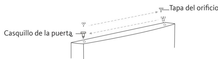
13. Retire los tapones de los orificios de los tornillos de la bisagra central del lado izquierdo del cuerpo del aparato y luego coloque estos tapones en los orificios de los tornillos del lado derecho del cuerpo del aparato.
