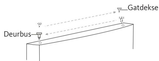
13. Verwijder de schroefgatpluggen van het middelste scharnier op de linkerzijde van de kast en monteer de pluggen in de schroefgaten aan de rechterzijde van de kast.
