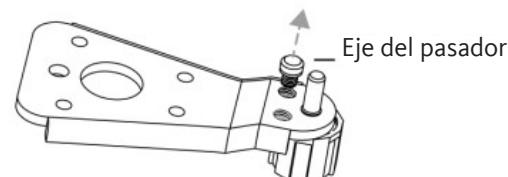
8. Inserte el eje del pasador en el orificio izquierdo de la bisagra inferior, después fije el eje con la arandela y la tuerca.
