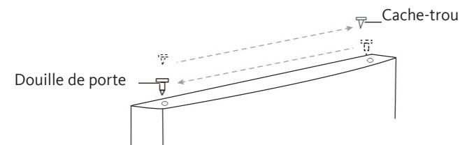
18. Retirez le cache-trou dans le coin supérieur gauche de l'appareil et fixez-le dans le coin supérieur droit.
