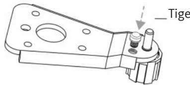
9. Installez la charnière inférieure sur le côté gauche de l'appareil.
