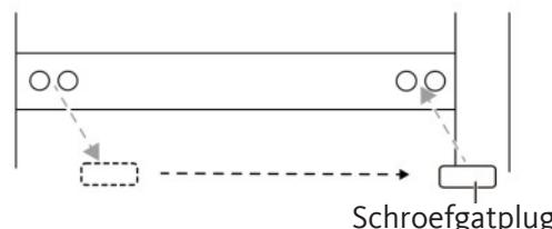
14. Monteer het middelste scharnier aan de linkerzijde met de twee schroeven die u eerder hebt verwijderd.
