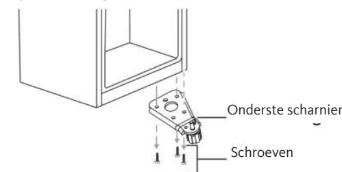
7. Verwijder de onderring en de moer waarmee de penas vastzit in het rechtergat van het onderste scharnier en verwijder vervolgens de penas.
