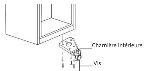
7. Retirez la rondelle et l'écrou qui maintiennent la tige dans le trou de droite de la charnière inférieure, puis retirez la tige.
