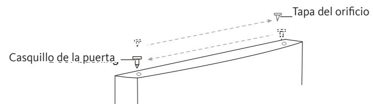
18. Retire la tapa del orificio del lado izquierdo superior del cuerpo del aparato y fije la tapa al lado derecho superior del cuerpo del aparato.
