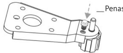
9. Bevestig het onderste scharnier aan de linkerzijde van de kast.
