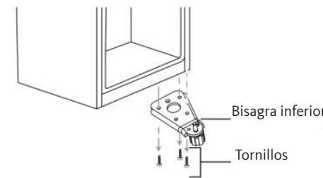
7. Retire la arandela y la tuerca que fijan el eje del pasador al orificio derecho de la bisagra inferior, después retire el eje
