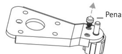
8. Steek de penas in het linker gat van het onderste scharnier en bevestig de as met de onderring en de moer.
