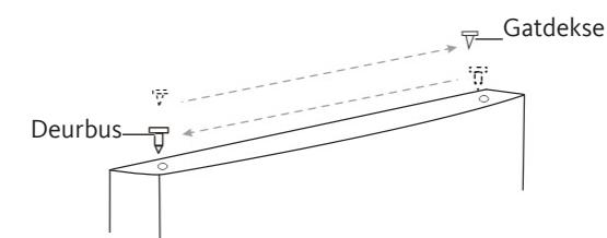
18. Verwijder het afdekplaatje van de linker bovenzijde van de kast en maak het deksel vast aan de rechter bovenzijde van de kast.
