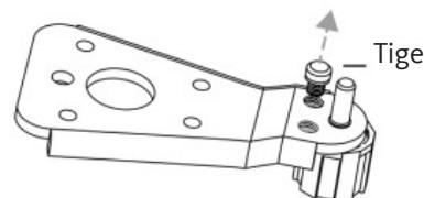
8. Insérez la tige dans le trou de gauche de la charnière inférieure, puis fixez la tige à l'aide de la rondelle et de l'écrou.
