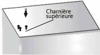
16. Installez le cache dissimulant les trous des vis en haut à droite de l'appareil. Installez le cache dissimulant la charnière supérieure (dans le sachet en plastique) du côté gauche. Rangez l'autre cache prévu pour la charnière supérieure dans le sachet en plastique.
