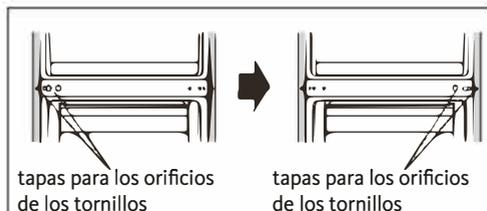
10. Coloque el frigorífico sobre un embalaje de espuma blanda o un material similar. Retire las dos partes de las patas inferiores ajustables y retire el panel de las patas delanteras y la parte de la bisagra inferior, desatornillando la brida especial de tornillos autorroscantes.
