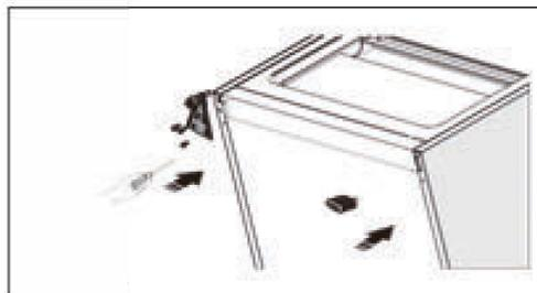
12. Coloque la puerta inferior en la posición adecuada, ajuste la pieza de la bisagra inferior, introduzca el eje de la bisagra en el orificio inferior de la puerta inferior y apriete los pernos
