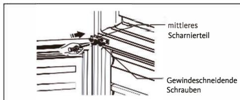
14. Setzen Sie die obere Tür in die richtige Position. Sichern Sie die Ausrichtung der Tür und setzen Sie die mittlere Scharnierachse in das untere Loch der oberen Tür.
