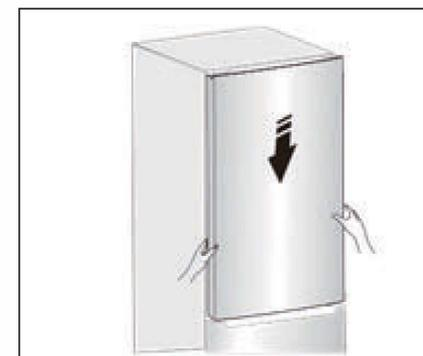
15. Placez la charnière supérieure de l'autre côté du réfrigérateur et introduisez l'axe de la charnière supérieure dans le trou supérieur de la porte du haut. Ajustez la position de la porte du haut (pendant ce temps, maintenez avec l'autre main la porte du haut plaquée sur l'appareil), puis fixez la charnière supérieure à l'aide des vis auto-taraudeuses à embase spéciale.
