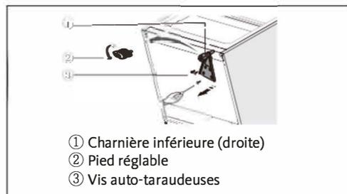
11. Déplacez ensuite la charnière inférieure de la droite vers la gauche de l'appareil et fixez-la à l'aide des vis auto-taraudeuses à embase spéciale. Réinstallez les pieds réglables de chaque côté et fixez-les.
