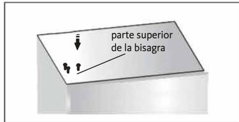
16. Instale la tapa del orificio del tornillo en el lado superior derecho del frigorífico. Instale la cubierta de la bisagra superior (que está en la bolsa de plástico) en la esquina izquierda. Coloque la otra cubierta de la bisagra superior en la bolsa de plástico.
