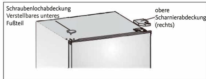
3. Schrauben Sie die gewindeschneidenden Spezialschrauben zur Befestigung des rechten oberen Scharnierteils mit einem 8-mm-Steckschlüssel oder einem Schraubenschlüssel heraus (stützen Sie dabei die obere Tür mit der Hand ab).
