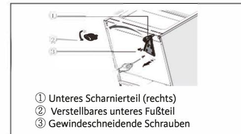
11. Bringen Sie das untere Scharnierteil wieder auf der linken Seite an und befestigen Sie es mit den gewindeschneidenden Spezialschrauben. Bringen Sie die verstellbaren unteren Fußteile wieder an auf die andere Seite und befestigen Sie sie.
