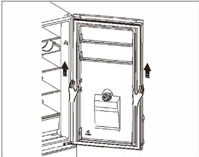
6. Plaats de bovenste deur op een zacht oppervlak met het paneel naar boven. Draai schroef ② en onderdeel ① los en installeer ze aan de linkerkant en draai ze stevig vast.
