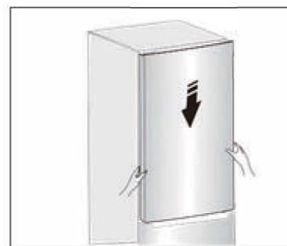
15. Verplaats de bovenste scharnier en plaats de bovenste scharnieras in het bovenste gat van de bovenste deur en pas de positie van de bovenste deur aan (ondersteun de bovenste deur met uw hand terwijl u dit doet) en maak de bovenste scharnier vast met de speciale zelftappende schroeven.
