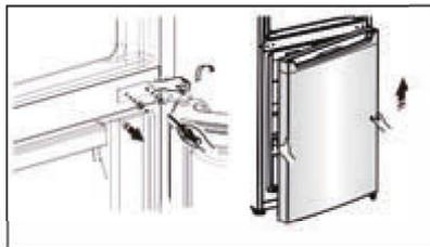
8. Legen Sie die untere Tür mit der Verkleidung nach oben auf eine weiche Unterlage. Lösen Sie die Schraube ② und das Teil ① und installieren Sie diese auf der linken Seite und ziehen Sie sie fest.
