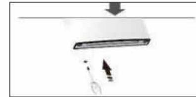
7. Draai de twee speciale zelftappende schroeven die worden gebruikt om de middelste scharnier te bevestigen, los en verwijder vervolgens de middelste scharnier die de onderste deur op zijn plaats houdt.
