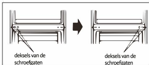
10. Leg de koelkast op de zachte schuimrubberen verpakking of gelijkwaardig materiaal. Verwijder beide verstelbare voeten onderaan en verwijder de plaat aan de voorkant en de onderste scharnier door de speciale zelftappende schroeven los te draaien.
