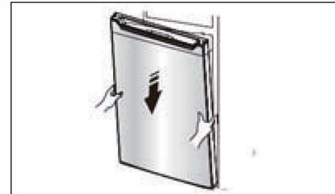
13. Faites pivoter la charnière centrale à 180°, placez-la de l'autre côté et ajustez sa position. Introduisez l'axe de la charnière centrale dans le trou supérieur de la porte du bas, puis vissez les vis.
