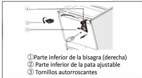
11. Vuelva a colocar la parte inferior de la bisagra hacia el lado izquierdo y fíjela con la brida especial de tornillos autorroscantes. Vuelva a colocar las piezas de las patas inferiores ajustables al otro lado y fíjelas.
