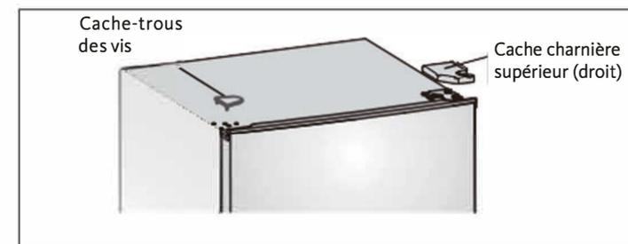
3. À l'aide d'une clé à molette ou d'une clé à douille de 8 mm, dévissez les vis auto-taraudeuses à embase spéciale qui fixent la charnière supérieure droite (pendant ce temps, maintenez avec l'autre main la porte du haut plaquée contre l'appareil).
