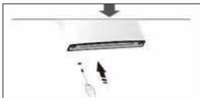
9. Verplaats de afdekplaatjes van de schroefgaten op de middelste afdekplaat van links naar rechts (zoals weergegeven op de onderstaande afbeelding).
