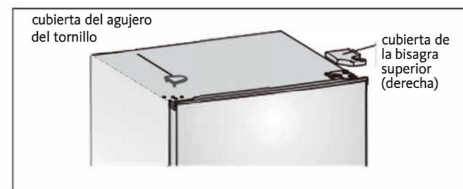
3. Desenrosque la brida especial de tornillos autorroscantes que se utilizan para fijar la parte superior derecha de la bisagra con una llave de tubo de 8 mm o una llave fija (al hacerlo, sujete la puerta superior con la mano).
