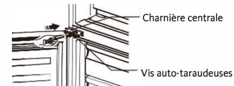
14. Positionnez correctement la porte du haut sur l'appareil. Ajustez la position de la porte, introduisez l'axe de la charnière centrale dans le trou inférieur de la porte du haut.
