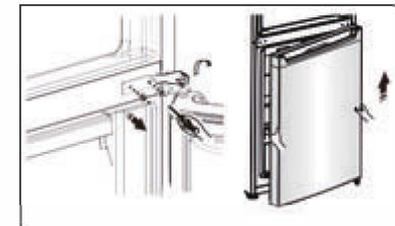
8. Plaats de onderste deur op een zacht oppervlak met het paneel naar boven. Draai schroef ② en onderdeel ① los en installeer ze aan de linkerkant en draai ze stevig vast.
