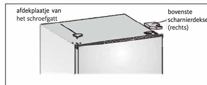
3. Draai de speciale zelftappende schroeven die gebruikt zijn om de scharnier rechts bovenaan te bevestigen los met een dopsleutel van 8 mm of een Engelse sleutel (gelieve de bovenste deur te ondersteunen met uw hand terwijl u dit doet).
