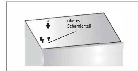
16. Installieren Sie die Schraubenlochabdeckung an der rechten oberen Ecke des Kühlschranks. Installieren Sie die obere Scharnierabdeckung (die sich in dem Plastikbeutel befindet) an der linken Ecke. Legen Sie die andere obere Scharnierabdeckung in den Plastikbeutel.
