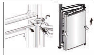
8. Posez la porte du bas sur une surface plane, face extérieure vers le haut. Dévissez la vis ② et la pièce ①, puis installez-les du côté gauche du réfrigérateur et serrez bien.
