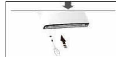
7. Desenrosque la brida especial de tornillos autorroscantes que se usan para fijar la parte de la bisagra central y retire la parte de la bisagra central que sujeta la puerta inferior.
