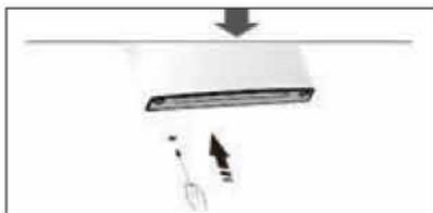
9. Cambie las tapas de los orificios de los tornillos en la placa de la cubierta central de izquierda a derecha (como se muestra en la siguiente figura).
