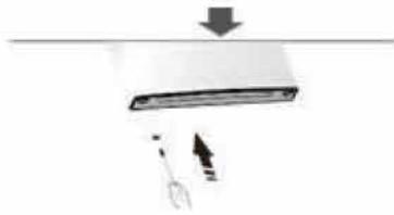
9. Déplacez les caches dissimulant les trous des vis de la plaque centrale de gauche à droite (comme illustré ci-dessous).
