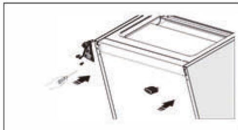
12. Positionnez correctement la porte du bas sur l'appareil, ajustez la charnière inférieure, introduisez l'axe de la charnière dans le trou inférieur de la porte du bas, puis vissez les vis.
