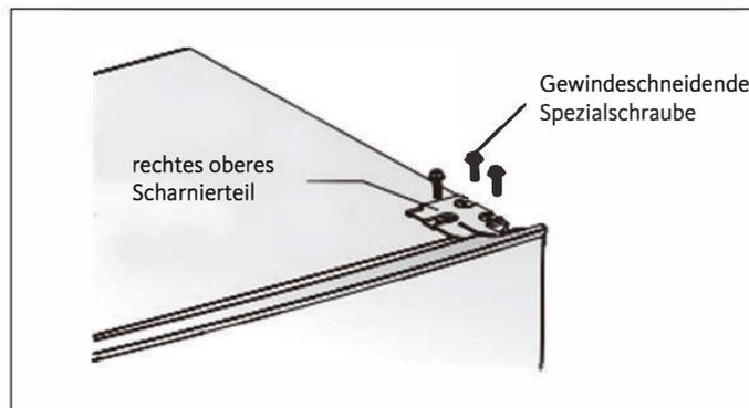
4. Entfernen Sie die obere Scharnierachse, versetzen Sie sie auf die gegenüberliegende Seite, ziehen Sie sie fest und legen Sie sie an einen sicheren Platz.
