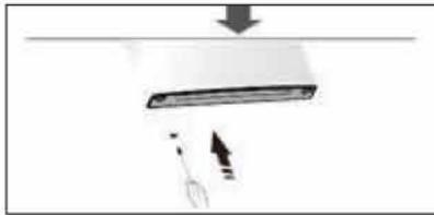
7. Schrauben Sie die gewindeschneidenden Spezialschrauben zur Befestigung des mittleren Scharnierteils heraus, entfernen Sie dann das mittlere Scharnierteil, das die untere Tür in Position hält.
