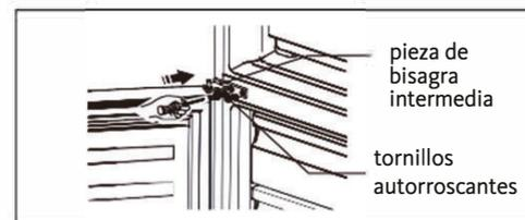
14. Mueva la puerta superior a la posición adecuada. Asegure el nivel de la puerta, haga que el eje de la bisagra central entre en el orificio inferior de la puerta superior
