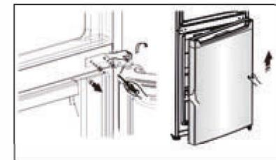
8. Coloque la puerta inferior sobre una superficie lisa con el panel hacia arriba. Afloje el tornillo ② y la pieza ①, instálelos en el lado izquierdo y apriételos de manera segura.
