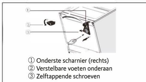
11. Plaats de onderste scharnier aan de linkerzijde en bevestig deze met de speciale zelftappende schroeven. Plaats de verstelbare voeten onderaan naar de andere kant en bevestig ze.
