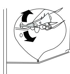
Este dispositivo de vaciado del agua se ensucia muy fácilmente y genera olores desagradables; acostúmbrase a limpiarlo periódicamente.
