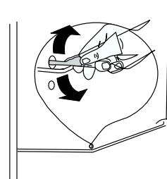
Diese Wasser-Ablaufvorrichtung verschmutzt sehr leicht und verursacht unangenehme Gerüche; gewöhnen Sie sich an, sie regelmäßig zu reinigen.
