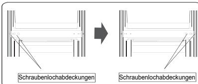
10. Legen Sie den Kühlschrank auf weiche Schaumverpackung oder ähnliches Material. Entfernen Sie beide einstellbaren Bodenfüße und entfernen Sie die vordere Fußplatte und das untere Scharnierteil, indem Sie die speziellen Flanschschneidschrauben abschrauben.
