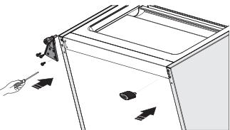
12. Transférez la porte inférieure sur la position de propriété, ajustez la partie inférieure de la charnière, faites rentrer l'axe de charnière dans le trou inférieur de la porte inférieure, puis serrez les boulons.
