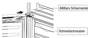
14. Bewegen Sie die obere Tür auf eine geeignete Position. Sichern Sie den Türgriff, stellen Sie die mittlere Scharnierachse in das untere Loch der oberen Tür.
