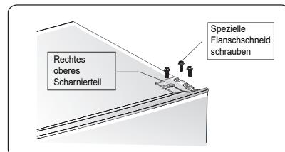
4. Entfernen Sie die obere Scharnierachse, bewegen Sie sie auf die umgekehrte Seite und ziehen Sie sie fest an, und legen Sie sie dann an einen sicheren Ort.
