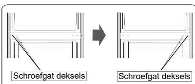
10. Leg de koelkast op zachte schuimverpakking of soortgelijk materiaal. Verwijder beide verstellbare voetjes aan de onderkant, en verwijder het onderste scharniergedeelte door de speciale flensschroeven los te schroeven.
