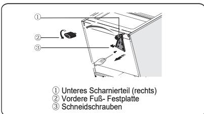
11. Ersetzen Sie das untere Scharnierteil auf die linke Seite und befestigen Sie es mit den speziellen Flanschschneidschrauben. Ersetzen Sie die verstellbare Fuß-Festplatte auf eine andere Seite und befestigen Sie sie.
