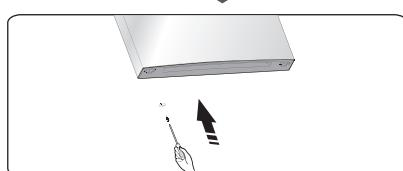
7. De twee speciale zelftappende flensschroeven losdraaien die worden gebruikt voor het bevestigen van het middelste scharnierdeel, vervolgens het middelste scharnierdeel dat de onderste deur vasthoudt verwijderen.
