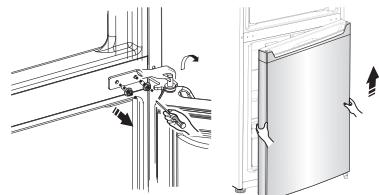
8. Plaats de onderste deur op een glad oppervlak met het paneel naar boven gericht. Schroef losdraaien ② en deel ①, en installeer ze vervolgens aan de linkerkant en stevig vastmaken.
