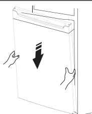
13. Het middelste scharnierdeel uit met een richting van 180 graden uitdraaien, zijn positie aanpassen, de sluitring plaatsen op de as van de bodem, de middelste scharnieraars in het bovenste opening van de onderste deur plaatsen, vastdraaien met schroeven.
