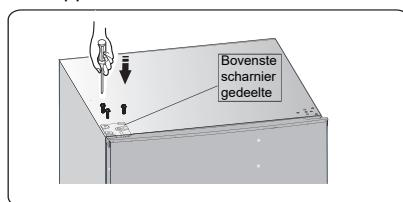
16. De Schroefgat deksel in de rechterbovenhoek van de koelkast installeren. Installeer de bovenste scharnieraars (in de plastic zak verpakt) aan de linkerkant. De andere bovenste scharnieraars in de plastic zak verpakken.
