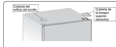
3. Desatornille los tornillos autorroscantes de la brida especial que se usan para fijar la pieza de bisagra superior derecha con un destornillador o una llave de 8 mm (sujete la puerta superior con la mano mientras lo haga).
