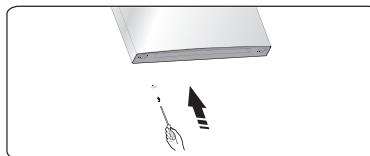
9. Wechseln Sie die Schraubenlochabdeckungen auf der mittleren Abdeckplatte von links nach rechts (siehe Abbildung unten).
