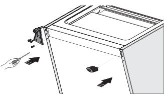
12. De onderste deur naar de juist plaats overbrengen, het onderste scharnierdeel aanpassen, plaatst de scharnieraars in het onderste opening van de onderste deur, vervolgens vastdraaien met de schroeven.
