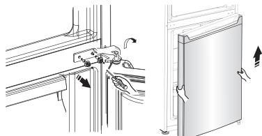
8. Coloque la puerta inferior sobre u superficie suave con el panel hacia arriba. Afloje el tornillo ② y la pieza ① y, a continuación, instálelos en el lado izquierdo y apriete bien.
