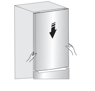
15. Transférez la partie supérieure de la charnière et faites rentrer l'axe de la charnière supérieure dans le trou supérieur de la porte supérieure, et ajustez la position de la porte supérieure (veuillez soutenir la porte supérieure avec la main), en fixant la partie supérieure de la charnière avec les vis autotaraudeuses spéciales à bride.
