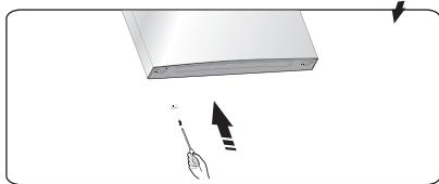
7. Dévisser les deux vis autotaraudeuses spéciales à bride qui servent à fixer la partie centrale de la charnière, puis retirer la partie centrale qui maintient la porte inférieure en place.
