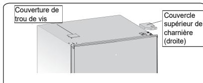
3. Dévisser les vis autotaraudeuses spéciales de la bride qui servent à fixer la partie supérieure droite de la charnière à l'aide d'une clé à douille de 8 mm ou d'une clé tricoises (en le faisant, veuillez soutenir la porte supérieure avec votre main).
