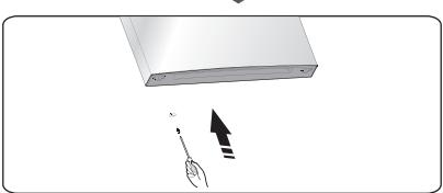
7. Schrauben Sie die beiden speziellen Flanschschneidschrauben ab, die zur Befestigung des mittleren Scharnierteils verwendet werden, und dann entfernen Sie das mittlere Scharnierteil, das die untere Tür befestigt.
