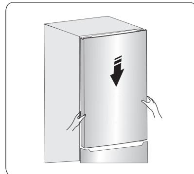
15. Cambie la pieza de la bisagra superior y coloque el eje de la bisagra superior en el orificio superior de la puerta superior y ajústela en la posición de la puerta superior (sujete la puerta superior con la mano mientras lo haga), fijando la pieza de la bisagra superior con los tornillos autorroscantes de la brida especial.
