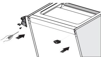
12. Bewegen Sie die untere Tür in die richtige Position, stellen Sie das untere Scharnierteil ein, und stellen Sie die Scharnierachse in das untere Loch der unteren Tür, und dann ziehen Sie die Schrauben fest.
