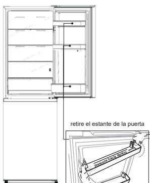
2. Utilice una espátula o un destornillador plano para levantar la cubierta del orificio del tornillo que hay en la esquina superior izquierda del refrigerador y la cubierta de la bisagra superior que hay en la esquina superior derecha del refrigerador.
