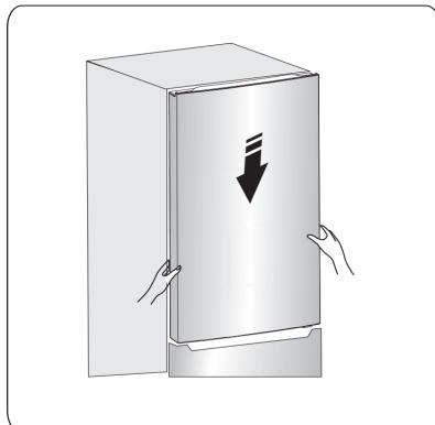
15. Het bovenste scharnierdeel overbrengen en de bovenste scharnieraars in het bovenste opening van de bovenste deur bevestigen, en de positie van de bovenste deur aanpassen (Ondersteun alsjeblieft de bovenste deur met uw hand wanneer u het uitvoert), het bovenste scharnierdeel met de speciale flens zelftappende schroeven vastdraaien.
