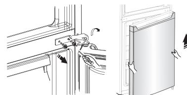
8. Legen Sie die untere Tür auf eine glatte Oberfläche mit seiner Verkleidung nach oben. Lösen Sie die Schraube ② und das Teil ①, und installieren Sie sie dann auf die linke Seite und sie fest anziehen.
