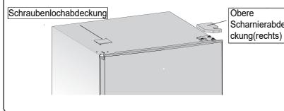
3. Lösen Sie spezielle Flanschschneidschrauben, die zur Befestigung des rechten oberen Scharnierteils verwendet werden, durch einen 8mm Steckschlüssel oder einen Schraubenschlüssel (Bitte tragen Sie die obere Tür mit der Hand, wenn Sie es tun).
