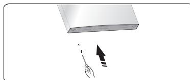
9. Changer de gauche à droite les couvercles des trous de vis sur la plaque de recouvrement centrale (comme indiqué sur la figure ci-dessous).
