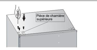
16. Installez le couvercle du trou de vis dans le coin supérieur droit du réfrigérateur. Installez le couvercle supérieur de la charnière (qui se trouve dans le sac en plastique) dans le coin gauche. Mettez l'autre couvercle supérieur de charnière dans le sac en plastique.
