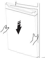
13. Retournez la partie de la charnière centrale à 180 degrés, ajustez sa position, changez la rondelle sur l'axe vers le côté inférieur, faites axer la charnière centrale dans le trou supérieur de la porte inférieure, serrez les vis.
