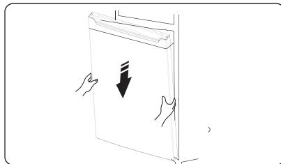
13. Vuelque la pieza de la bisagra central en 180 grados, ajuste la posición, cambie la arandela en el eje del lado inferior colocando el eje de la bisagra central en el orificio superior de la puerta inferior y apriete los tornillos.
