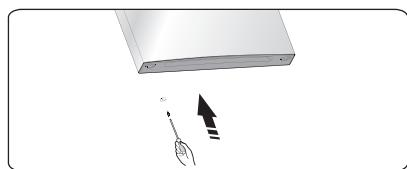
7. Desatornille los dos tornillos autorroscantes de la brida especial que se usan para fijar la pieza de la bisagra central y, a continuación, retire la pieza de la bisagra central que sujetla la puerta inferior.
