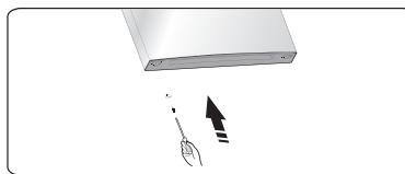
9. Cambie las cubiertas de l orificios de los tornillos de la parte central de la placa de cubierta de izquierda a derecha (como se muestra en la figura siguiente).
