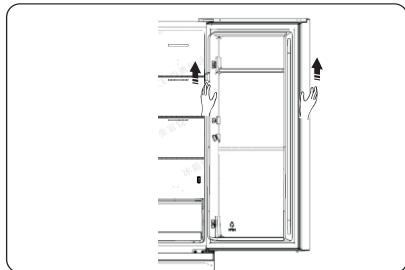
6. Coloque la puerta superior sobre u superficie suave con el panel hacia arriba. Afloje el tornillo ② y la pieza ① y, a continuación, instálelos en el lado izquierdo y apriete bien.
