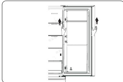
6. Plaats de bovenste deur op een glad oppervlak met het paneel naar boven gericht. Schroef losdraaien ② en deel ①, en installeer ze vervolgens aan de linkerkant en stevig vastmaken.
