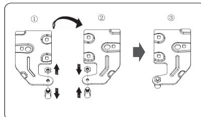
5. Entfernen Sie die obere Tür vom mittleren Scharnier durch vorsichtiges Heben der Tür gerade nach oben.
