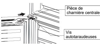
14. Transférez la porte supérieure à la position appropriée. Fixez le niveau de la porte, faites rentrer l'axe de la charnière centrale dans le trou inférieur de la porte supérieure.
