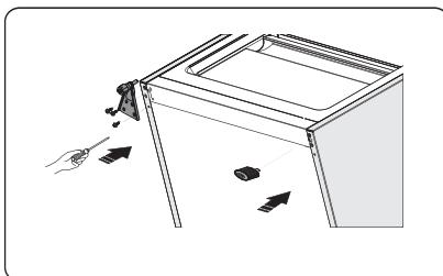
12. Cambie la puerta inferior a la posición de propiedad, ajuste la pieza de bisagra inferior colocando el eje de bisagra en el orificio inferior de la puerta inferior y, a continuación, apriete los tornillos.
