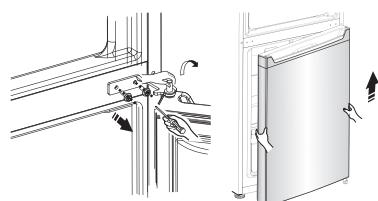
8. Placez la porte inférieure sur une surface lisse avec son panneau vers le haut. Desserrez la vis ② et la pièce ①, puis installez-les sur le côté gauche et serrez-les fermement.
