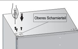
16. Installieren Sie die Schraubenlochabdeckung auf der oberen rechten Ecke des Kühlschranks. Montieren Sie die obere Scharnierabdeckung (in der Plastiktüte) auf der linken Ecke. Setzen Sie die andere obere Scharnierabdeckung in die Plastiktüte.
