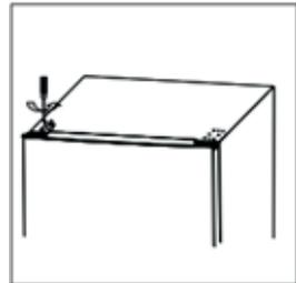
13. Die Scharnierabdeckung auf der linken Seite und die Scharnierlochabdeckung auf der rechten Seite befestigen.
