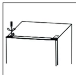
13. Fije la tapa de la bisagra a la izquierda y la tapa del orificio de la bisagra a la derecha.
