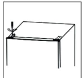
13. Plaats het scharnierdeksel links en het scharniergatdeksel rechts.
