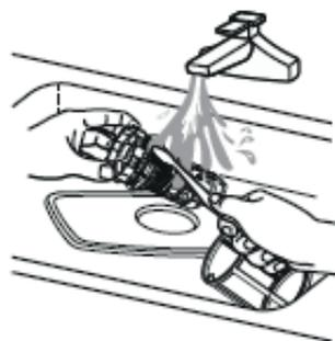
5. Remontez les filtres dans l'ordre inverse du démontage, replacez le groupe filtre et tournez-le dans le sens des aiguilles d'une montre jusqu'à la flèche correspondant à la position fermée.
