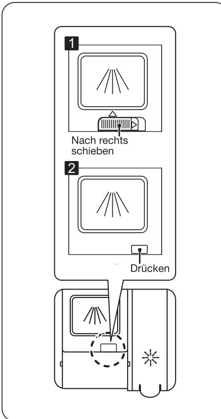
1. Öffnen Sie den Deckel entsprechend des von Ihnen verwendeten Produkts.
