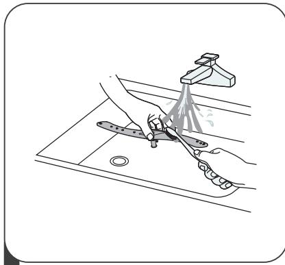
3 Was de sproeiarmen met lauw zeepsop en gebruik een zachte borstel om de jets te reinigen. Nadat u ze goed gespoeld hebt, plaatst u ze terug.
