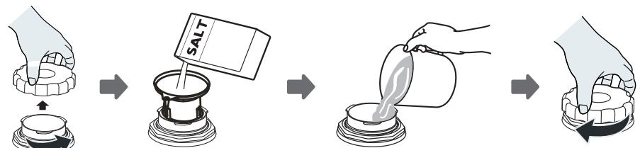
1. Haal de onderste mand uit het toestel en schroef de dop van het compartiment.
