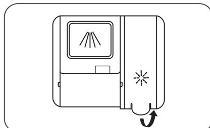
1. Retirez le cache du compartiment à produit de rinçage en soulevant la languette.
