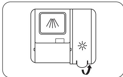
1. Verwijder het afdekplaatje van het spoelmiddel door het lipje omhoog te trekken.
