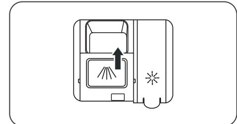
3. Schieben Sie die Abdeckung, indem Sie sie nach vorne schieben und gleichzeitig darauf drücken.
