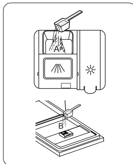
2. Giet het vaatwasmiddel in de grootste opening (A) voor de hoofdwascyclus. Giet voor betere resultaten, zeker wanneer de vaat erg vuil is, een kleine hoeveelheid detergents in de kleine opening (B). Deze bijkomende hoeveelheid detergents wordt gebruikt tijdens de voorwasfase.
