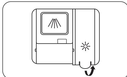
1. Entfernen Sie die Abdeckung des Klarspülerfachs, indem Sie die Lasche anheben.
