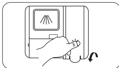
2. Versez le produit de rinçage dans le compartiment, en veillant à ne pas trop le remplir.
