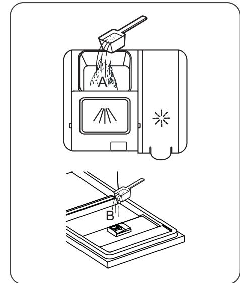
2. Für den Hauptspülgang Reinigungsmittel in die große Kammer (A) geben. Um optimale Spülergebnisse zu erzielen, insbesondere wenn das Geschirr stark verschmutzt ist, geben Sie eine kleine Menge Reinigungsmittel in die kleine Kammer (B). Diese zusätzliche Reinigungsmittelmenge wird in der Vorspülphase verwendet.
