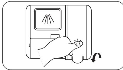
3. Die Kammer durch Herunterklappen des Deckels schließen.
