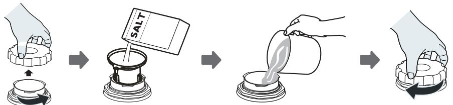
1. Den unteren Korb herausziehen und den Deckel des Behälters abschrauben.
