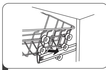
3 Vuelva a colocar la cesta superior sobre los rodillos de la parte superior o inferior.
