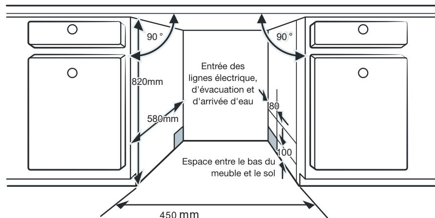
2. Si le lave-vaisselle est installé à côté d'un meuble en coin, il convient de prévoir un espace suffisant pour l'ouverture de la porte.
