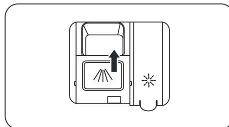
3. Sluit het afdekplaatje door het naar voor te schuiven en door erop te drukken.
