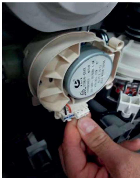
câbles du dérivateur
