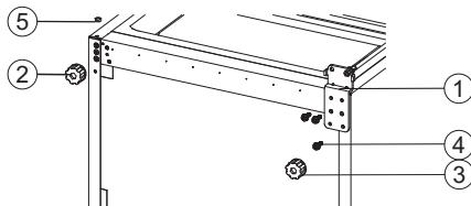
8. Schroef het onderste scharnier los, verander het in het dichtsbijzijnde schroefgat, en het vervolgens vastdraaien.
