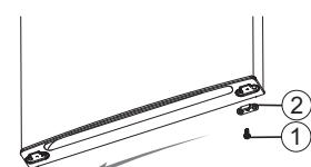
6. Changer de gauche à droite les couvercles des trous de vis sur la plaque de recouvrement centrale (comme indiqué sur la figure ci-dessous).
