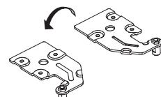
12. Entfernen Sie die linke Schraubenloch-Abdeckung ①, dann installieren Sie die rechte Schraubenloch-Abdeckung ② (im Kunststoffbeutel), wie in der Abbildung unten gezeigt.
