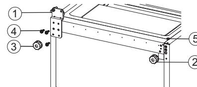
10. Mueva la puerta inferior y ajústela en una posición alineada al orificio inferior y al eje de la bisagra superior. Gire la bisagra media a 180, ajuste la bisagra media a la posición correcta y luego instálela.
