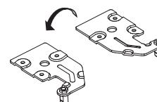
12. Verwijder de linker schroefgat afdekking ①, tinstalleer vervolgens de rechter schroefgat afdekking ② (in de plastic zak), zoals weergegeven in de onderstaande afbeelding.
