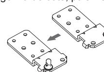
9. Reprenez l'étape 7, changez l'élément ① de place en le mettant à gauche et transférez les éléments ②, et ⑤ sur la droite, puis fixez l'élément ① au moyen de vis ④. Installez pour finir l'élément ③.
