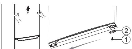
4. Maak de schroeven ① los die worden gebruikt om het middelste scharnier ② vast te zetten en verwijder het middelste scharnier ②. Verwijder vervolgens de onderste deur.
