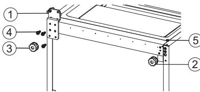
10.Verschieben Sie die untere Tür und stellen Sie ihre Position, um untere Lochstelle und oberen Scharnierachse auszurichten. Drehen Sie das mittlere Scharnier um 180, stellen Sie das mittlere Scharnier in die entsprechende Position und installieren Sie es.
