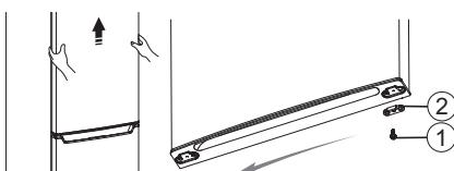
4. Löse Schrauben ①, die zur Befestigung des mittleren Scharniers ② verwendet werden, und entfernen Sie das mittlere Scharnier ②. Entfernen Sie dann die untere Tür.
