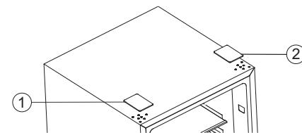
13. Déplacez la porte supérieure dans la bonne position, ajustez l'élément ① et la porte supérieure puis fixez l'élément ① au moyen des vis ② (Maintenez la porte supérieure avec votre main pendant l'installation), puis installez l'élément ③ (dans le sachet plastique).
