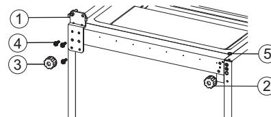
10. Déplacez la porte inférieure et ajustez-la dans la bonne position en alignant bien la fente inférieure à l'axe de la charnière supérieure. Faites pivoter la charnière centrale de 180°C, ajoutez-la dans la bonne position puis installez-la.
