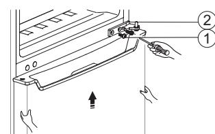
5. Legen Sie die untere Tür auf einer glatten Oberfläche mit seinen Platte nach oben. Lockern Sie die Schrauben ① und entfernen Sie Teil ② und dann installieren Sie Teil ② auf der linken Seite mit Schrauben ①.
