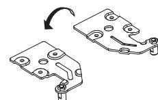
12. Quite el cobertor del orificio del tornillo izquierdo ①. Luego, instale el cobertor del orificio del tornillo derecho ② (en la bolsa de plástico) como se muestra en la siguiente imagen.
