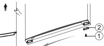
4. Suelte los tornillos ① utilizados para fijar la bisagra② de en medio y quite la misma bisagra②. Despues, quite la puerta inferior.
