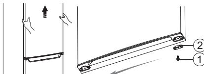
4. Desserrer les vis ① utilisées pour fixer la charnière centrale ② et retirer la charnière centrale ②. Puis, enlever la porte inférieure.
