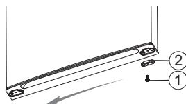
6. Cambie las cubiertas de los orificios de los tornillos de la parte central de la placa de cubierta de izquierda a derecha (como se muestra en la figura siguiente).
