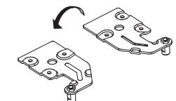
12. Retirez le cache du trou de vis gauche ①, puis installez le cache du trou de vis droit ② (dans le sachet plastique), comme sur le schéma ci-dessous.
