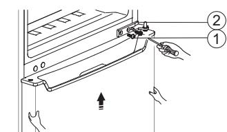
5. Plaats de onderste deur op een vlak oppervlak met het paneel naar boven gericht. De schroeven losdraaien ①, en verwijder deel ②, installeer vervolgens deel ② aan de linkerkant met schroeven ①.
