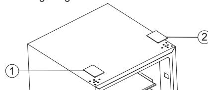
13. Stellen Sie den oberen Tür zu geeigneter Position, stellen Sie Teil ① und obere Tür ein, und dann befestigen Teil ① durch Schrauben ② (Bitte halten obere Tür mit der Hand bei der Installation), und installieren Sie dann einen anderen Teil ③ (in den Plastikbeutel).
