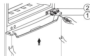
5. Placez la porte inférieure sur une surface souple, la face extérieure vous faisant face. Desserrez les vis ①, puis retirez l'élément ②, puis installez l'élément ② sur la gauche au moyen des vis ①.
