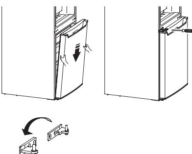
11.Schrauben Sie die oberen Scharnierachse, drehen Sie den oberen Scharnier über und befestigen Achse auf sie. Dann legen Sie es an der Seite für den Einsatz.
