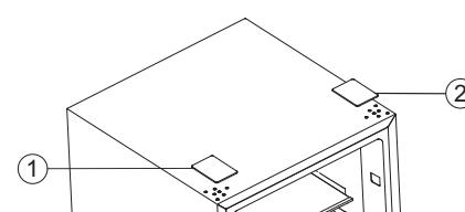
13. Mueva la puerta superior en la posición correcta, ajuste la parte ① y la puerta superior y, luego, fije la parte ① con los tornillos ② (Sostenga la puerta superior con la mano cuando la instale) y luego, instale la otra parte ③ (en la bolsa de plástico).
