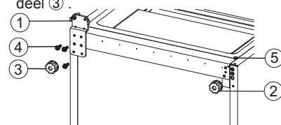
10. Verwijder de onderste deur en de positive afstellen met het onderste schroefgat en de bovenste scharniers. Draai de middelste scharnier 180, de middelste scharnier naar de juiste positie aanpassen en vervolgens installeren.
