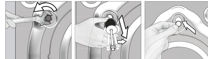
**IMPORTANT** : les vis de bridage servant à prévenir tout dommage interne lors du transport, celles-ci doivent être retirées avant de faire fonctionner le lave-linge ! Dans le cas contraire, l'appareil sera endommagé et ceci n'est pas couvert par la garantie.
