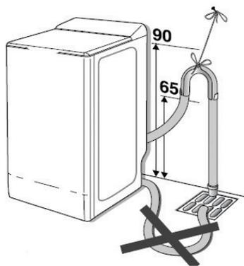
**Important :** Veillez à bien maintenir le tuyau de vidange au moyen d'un lien afin d'éviter que la crosse ne se dégage en cours de vidange et provoque une inondation.
