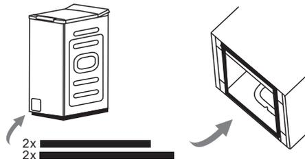
1. Posez la machine sur le sol, en utilisant un matériau souple comme de la mousse ou des vêtements pour protéger l'appareil.
