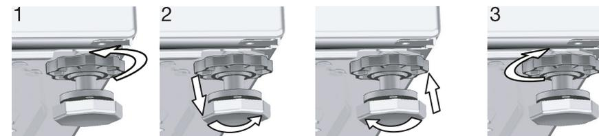
L'appareil doit être mis à niveau et équilibré sur ses pieds afin qu'il fonctionne de façon silencieuse et sans vibration. Procédez pour cela au réglage des pieds à l'aide d'un niveau à bulle.
