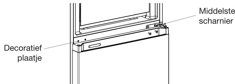
3. Verwijder de deur van de diepvriezer. Zorg ervoor dat u de kleine onderdelen niet verliest, zoals de schachtbus en de deurstop.
