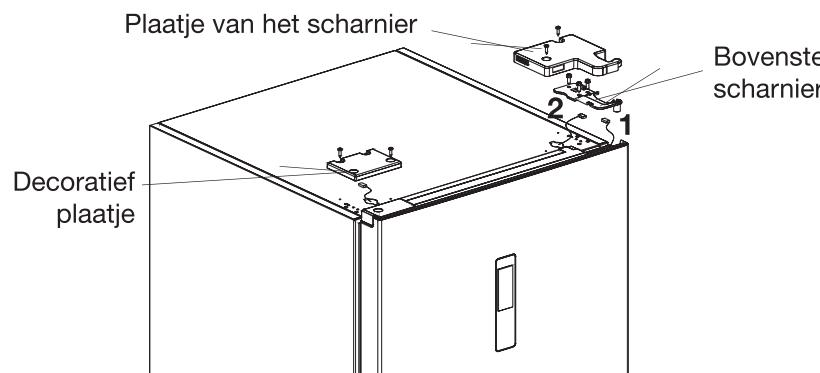
2. Verwijder de deur van de koelkast. Zorg ervoor dat u de kleine onderdelen niet verliest, zoals de schachtbus en de deurstop.
