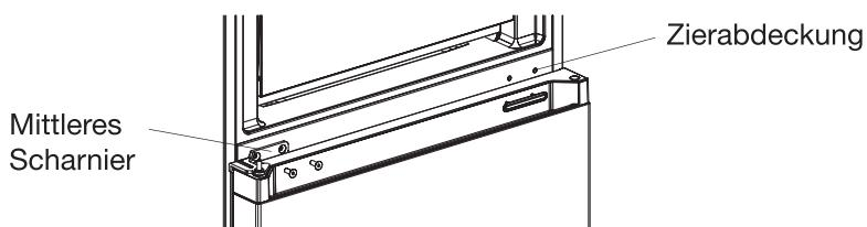
7. Die Kühlzimmerschranktür auf dem mittleren Scharnier installieren und das obere linke Scharnier installieren. Die Signalleitung 3 der Oberseite des Kühlzimmers mit der Signalleitung 1. Die Zierblende des Scharniers auf der rechten Seite wieder anbringen. (Hinweis: beim Austausch der Zierblende des Scharniers auf der rechten Seite müssen die beiden Einsätze der Zierblende des Scharniers abgeschnitten werden).
