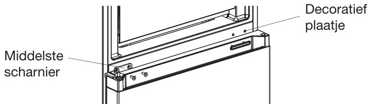
7. Plaats de deur van de koelkast op het middelste scharnier en plaats het bovenste scharnier links. Verbind signaallijn 3 van de bovenkant van de koelkast met signaallijn 1. Plaats het decoratieve plaatje van het scharnier aan de rechterkant. (Opmerking: Wanneer u het decoratieve plaatje van het scharnier aan de rechterkant plaatst, moeten de twee inzetstukken van het decoratieve plaatje van het scharnier losgemaakt worden).
