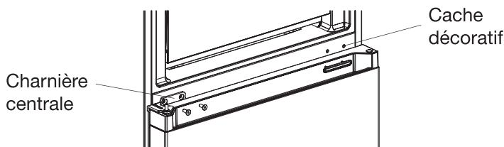
7. Installez la porte du réfrigérateur sur la charnière centrale et installez la charnière supérieure gauche. Connectez la ligne de signal 3 du haut du réfrigérateur à la ligne de signal 1. Replacez le cache décoratif de la charnière sur le côté droit. (Remarque : lors du remplacement du cache décoratif de la charnière sur le côté droit, les deux inserts du cache décoratif de la charnière doivent être coupés).
