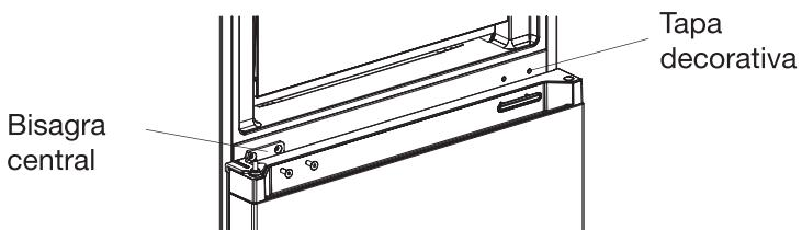
7. Instale la puerta del frigorífico sobre la bisagra central e instale la bisagra superior izquierda. Conecte la línea de señal 3 de la parte superior del frigorífico a la línea de señal 1. Cambie la tapa decorativa de la bisagra al lado derecho. Observación: durante el cambio de la tapa decorativa de la bisagra al lado derecho, los dos insertos de la tapa decorativa de la bisagra deben estar cortados).
