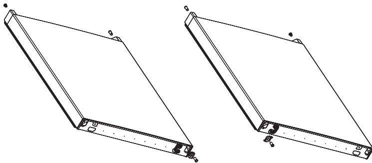
6. Installeer de deur van de diepvriezer op het laagste scharnier. Plaats dan het middelste scharnier en het decoratieve plaatje.
