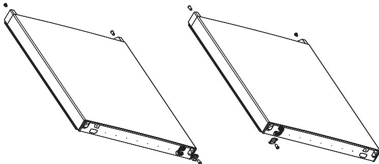
6. Die Gefrierschranktür auf dem unteren Scharnier installieren und dann das mittlere Scharnier und die dekorative Zierblende installieren.
