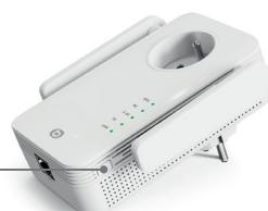
En cas de problème de connexion ou de dysfonctionnement, nous vous conseillons de réinitialiser votre répéteur Wi-Fi à ses paramètres d'usine, en maintenant appuyé le bouton RST pendant 10 secondes.
