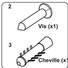
Le sac de documentation contient un kit antibasculément. Fixer le dispositif antibasculément (1) sur le mur à l'aide de la vis (2) et de la cheville (3), conformément aux dimensions de l'illustration et du tableau ci-dessous. Régler la hauteur du dispositif antibasculément pour l'aligner sur la rainure de la cuisinière, puis serrer la vis (2). Pousser l'appareil vers le mur en s'assurant que le dispositif antibasculément est inséré dans la rainure à l'arrière de l'appareil.
