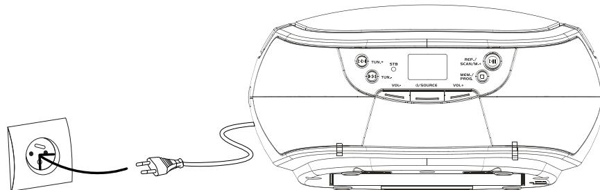
Branchez une extrémité du câble d'alimentation sur le connecteur d'alimentation situé au dos de la radio. Puis branchez l'autre extrémité sur une prise murale. Le témoin lumineux rouge de mise sous tension s'allume.
