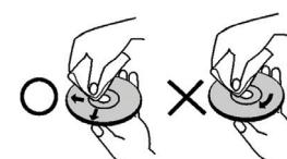
Verwenden Sie niemals Alkohol, Benzol, Verdünner, Reinigungsflüssigkeiten oder andere Chemikalien. Verwenden Sie zum Entfernen von Staub keine Druckluft.
