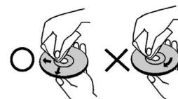
N'utilisez jamais d'alcool, de benzène, de diluant, de liquide nettoyant ou d'autres produits chimiques. N'utilisez pas d'air comprimé pour nettoyer les poussières.
