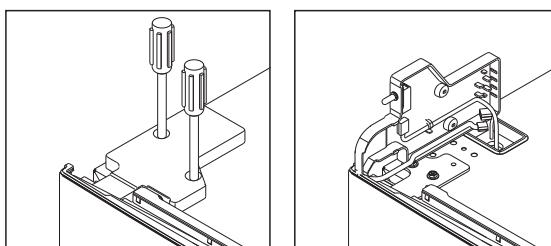
7. En la parte inferior del frigorífico, desenrosque y retire las patas ajustables. Desatornille los tres tornillos de la bisagra inferior derecha y retire la bisagra del frigorífico.
