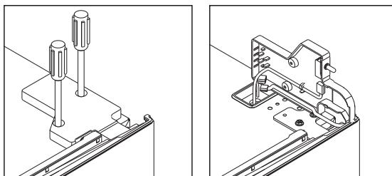
5. Desatornille la bisagra superior derecha. Para ello, afloje los tres tornillos con una llave de tubo y luego use un destornillador de estrella para quitarlos.
