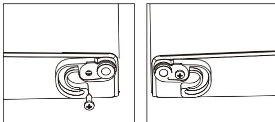
9. À l'aide d'une clé réglable, dévissez la broche de la charnière supérieure et placez-la en haut de la charnière au lieu du bas. Placez la charnière sur les trous de vis de charnière du côté gauche et fixez-la à l'aide des trois vis de charnière. Serrez les vis à l'aide de la clé à douille.
