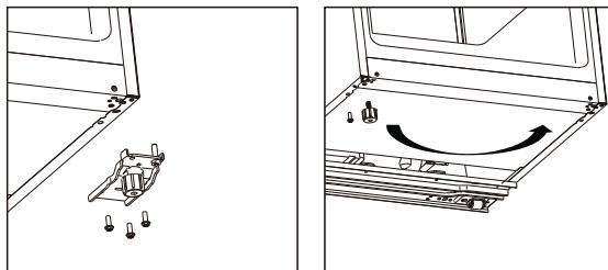
8. Dévissez le dispositif de fermeture droit. Sortez le dispositif de fermeture gauche du sac d'accessoires et installez-le du côté gauche.
