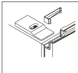
4. Desatornille los dos tornillos de la cubierta de la bisagra superior derecha. Para ello, afloje los tornillos con una llave de tubo y luego use un destornillador de estrella para quitarlos.
