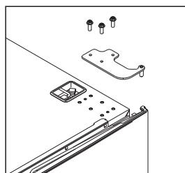
6. Lösen Sie die Schrauben der oberen linken Scharnierabdeckung und nehmen Sie die Abdeckung ab.
