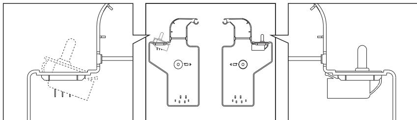
11. Sluit de draadschakelaar en de draadconnectoren van het display aan en plaats vervolgens de draden in de clips binnenin de scharnieraafdekking. Bekijk de foto die u eerder hebt genomen om u te helpen bij deze stap. Maak de linker scharnieraafdekking op zijn plaats vast.
