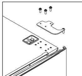
6. Draai de schroeven in de scharnieraafdekking linksboven los en verwijder de afdekking.
