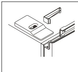
4. Desserrez les deux vis situées sur le cache de la charnière supérieure droite. Pour ce faire, desserrez les vis à l'aide d'une clé à douille, puis utilisez un tournevis cruciforme pour les retirer.
