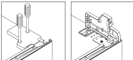
5. Schrauben Sie das rechte obere Scharnier ab. Lösen Sie dazu die drei Schrauben mit einem Steckschlüssel und verwenden Sie dann einen Kreuzschlitzschraubendreher, um sie zu entfernen.
