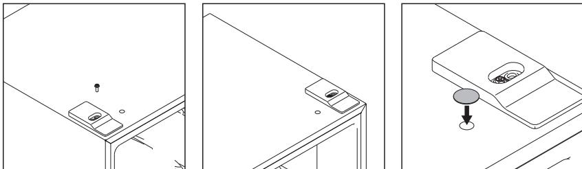
14. Con una llave ajustable, desatornille y mueva el pasador de bisagra de la bisagra inferior hacia el orificio del pasador de la bisagra adyacente. Coloque la bisagra sobre los orificios de los tornillos de la bisagra superior derecha y fíjela en su posición con los tres tornillos de la bisagra. Apriete los tornillos con la llave de tubo.
