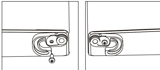
9. Draai met een verstelbare sleutel de scharnierpen op het bovenste scharnier los en breng deze van de onderkant naar de bovenkant. Plaats het scharnier over de schroefgaten van het scharnier aan de linkerkant en bevestig het op zijn plaats met de drie scharnierschroeven. Draai de schroeven vast met de dopsleutel.
