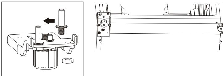
15. Vuelva a instalar las patas ajustables. Si es necesario, ajuste las patas ajustables para nivelar el frigorífico.
