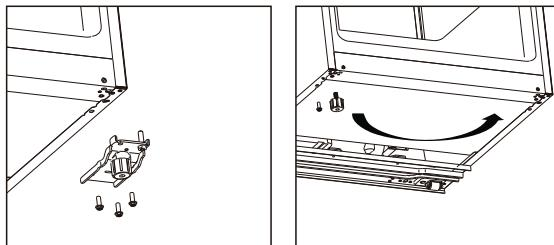
8. Schroef de rechter deursluiting los en verwijder deze. Haal de linker deursluiting uit het zakje met accessoires en installeer deze aan de linkerkant.
