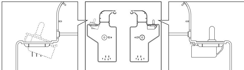
11. Schließen Sie die Kabelstecker des Türschalters und des Displays an und stecken Sie die Kabel in die Clips in der Scharnierabdeckung. Schauen Sie sich zur Unterstützung bei diesem Schritt das Foto an, das Sie zuvor gemacht haben. Bringen Sie die linke Scharnierabdeckung an.
