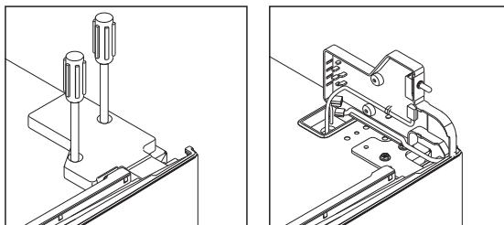
5. Dévissez la charnière supérieure droite. Pour ce faire, desserrez les trois vis à l'aide d'une clé à douille, puis utilisez un tournevis cruciforme pour les retirer.
