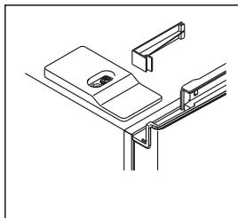
4. Draai de twee schroeven van de scharnieraafdekking rechtsboven los. Om dit te doen, draai de schroeven los met een dopsleutel en gebruik vervolgens een kruiskopschroevendraaier om ze te verwijderen.
