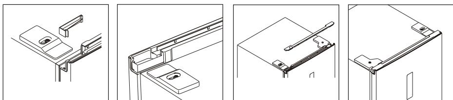
13. Vuelva a instalar la cubierta de la bisagra en el lado derecho sobre los orificios de los tornillos. Retire la cinta de la tapa gris del orificio del tornillo (que se puede encontrar en la bolsa de accesorios) y presione la tapa gris firmemente sobre el orificio del tornillo expuesto.
