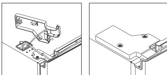
12. Vuelva a instalar las cubiertas de la caja de cables.
