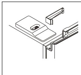
4. Lösen Sie die beiden Schrauben an der oberen rechten Scharnierabdeckung. Lösen Sie dazu die Schrauben mit einem Steckschlüssel und verwenden Sie dann einen Kreuzschlitzschraubendreher, um sie zu entfernen.
