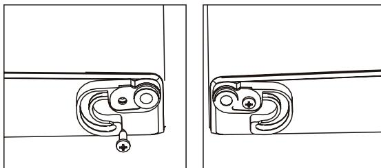
9. Con una llave ajustable, desatornille y mueva el pasador de bisagra de la bisagra superior desde el lado inferior hacia el lado superior. Coloque la bisagra sobre los orificios de los tornillos de la bisagra del lado izquierdo y fíjela en su posición con los tres tornillos de la bisagra. Apriete los tornillos con la llave de tubo.
