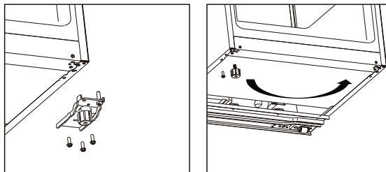
8. Schrauben Sie den rechten Türstopper ab und entfernen Sie ihn. Nehmen Sie den linken Türstopper aus dem Zubehörbeutel und montieren Sie ihn auf der linken Seite.
