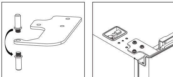
10. Nehmen Sie den Türschalter aus der rechten oberen Scharnierabdeckung heraus, indem Sie die Unterseite des Schalters nach oben drücken. Setzen Sie ihn dann in die linke obere Scharnierabdeckung ein, die Sie im Zubehörbeutel finden.
