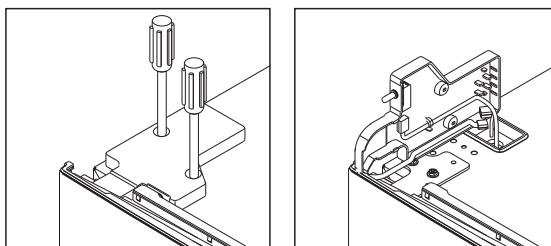
7. Dévissez et retirez les pieds réglables situés au dessous du réfrigérateur. Desserrez les trois vis de la charnière inférieure droite et retirez la charnière du réfrigérateur.
