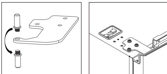
10. Retirez l'interrupteur de porte du cache de la charnière supérieure droite en poussant le bas de l'interrupteur vers le haut, puis en l'installant dans le cache de la charnière supérieure gauche, qui se trouve dans le sac d'accessoires.
