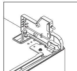
5. Schroef het scharnier rechtsboven los. Om dit te doen, draai de drie schroeven los met een dopsleutel en gebruik vervolgens een kruiskopschroevendraaier om ze te verwijderen.
