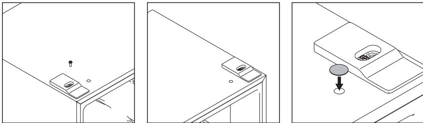
14. Schrauben Sie den Scharnierstift des unteren Scharniers mit einem verstellbaren Schraubenschlüssel heraus und versetzen Sie ihn in das angrenzende Scharnierstiftloch. Setzen Sie das Scharnier auf die Scharnier-Schraubenlöcher oben rechts und befestigen Sie es mit den drei Scharnierschrauben. Ziehen Sie die Schrauben mit dem Steckschlüssel fest.
