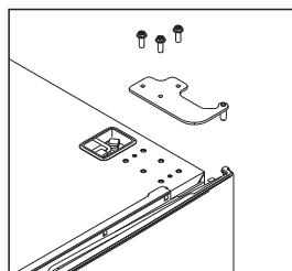
6. Desatornille los tornillos de la cubierta de la bisagra superior izquierda y retire la cubierta.
