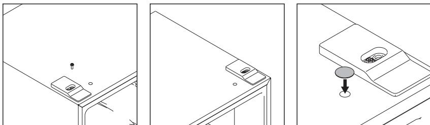
14. Draai met een verstelbare sleutel de scharnierpen op het onderste scharnier los en breng deze naar het aangrenzende scharnierpengat. Plaats het scharnier over de schroefgaten van het bovenste rechter scharnier en bevestig het op zijn plaats met de drie scharnierschroeven. Draai de schroeven vast met de dopsleutel.
