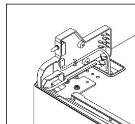
7. Aan de onderkant van de koelkast, schroef de stelvoetjes los en verwijder ze. Draai de drie schroeven van het scharnier rechtsonder los en verwijder het scharnier van de koelkast.
