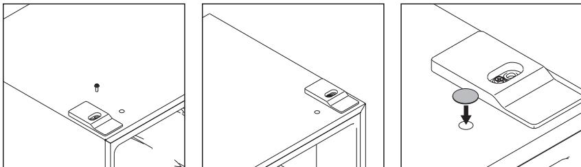
14. À l'aide d'une clé réglable, dévissez la broche de la charnière inférieure et déplacez-la de la charnière inférieure vers le trou de broche de charnière adjacent. Placez la charnière sur les trous de vis de la charnière supérieure droite et fixez-la à l'aide des trois vis de charnière. Serrez les vis à l'aide de la clé à douille.
