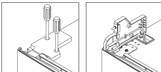
7. Schrauben Sie die Stellfüße an der Unterseite des Kühlschranks ab und nehmen Sie sie ab. Lösen Sie die drei Schrauben am rechten unteren Scharnier und entfernen Sie das Scharnier vom Kühlschrank.
