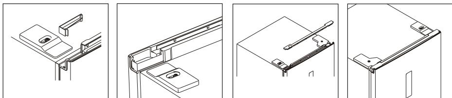
13. Plaats de scharnieraafdekking weer aan de rechterkant over de schroefgaten. Verwijder de tape van de grijze schroefgatafdekking (die te vinden is in het zakje met accessoires) en druk de grijze afdekking stevig over het blootgestelde schroefgat.
