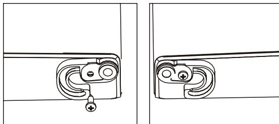
9. Schrauben Sie den Scharnierstift am oberen Scharnier mit einem verstellbaren Schraubenschlüssel heraus und versetzen Sie ihn von der Unterseite auf die Oberseite. Setzen Sie das Scharnier auf die Scharnier-Schraubenlöcher auf der linken Seite und befestigen Sie es mit den drei Scharnierschrauben. Ziehen Sie die Schrauben mit dem Steckschlüssel fest.
