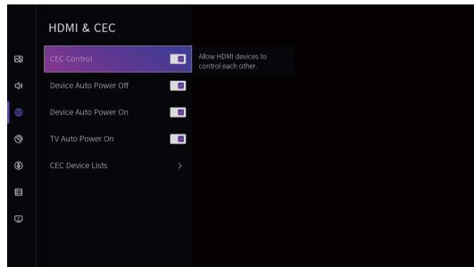
Drücken Sie die Taste **▼ / ▲**, um CEC-Steuerung/Gerät automatisch einschalten/Gerät automatisch ausschalten/TV automatisch einschalten/CEC-Gerätelisten auszuwählen.
