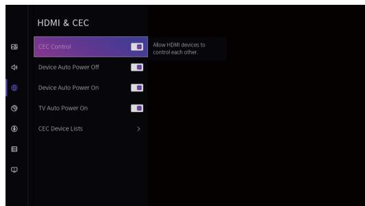
Druk op de **▼/▲**-knop om CEC-bediening/Automatisch inschakelen apparaat/Automatisch uitschakelen apparaat/Automatisch inschakelen TV/CEC-apparaatlijsten te selecteren.
