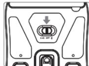
Deslice el selector de modo a la posición **OFF**. Se apagará el indicador luminoso.
