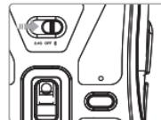
Deslice el selector de modo a la posición . Pulse brevemente el botón de emparejamiento para seleccionar el canal bluetooth\*: el indicador luminoso se encenderá en verde para el canal **BT1** o azul para el canal **BT2**.
