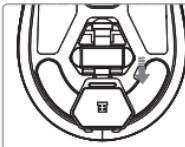
Haal de USB-ontvanger uit het vak en sluit hem aan op een vrije USB-poort van uw computer.
