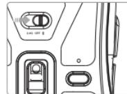
Faites coulisser le bouton de sélection du mode en position **Bluetooth**. Appuyez brièvement sur le bouton d'appairage pour sélectionner le canal bluetooth\* : le témoin lumineux s'allume en vert pour le canal **BT1** ou en bleu pour le canal **BT2**.
