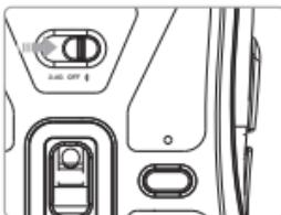
Faites coulisser le bouton de sélection du mode en position **Bluetooth**. Appuyez brièvement sur le bouton d'appairage pour sélectionner le canal bluetooth\* : le témoin lumineux s'allume en vert pour le canal **BT1** ou en bleu pour le canal **BT2**.
