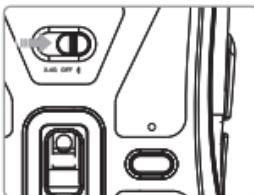
Deslice el selector de modo a la posición . Pulse brevemente el botón de emparejamiento para seleccionar el canal bluetooth\*: el indicador luminoso se encenderá en verde para el canal BT1 o azul para el canal BT2.
