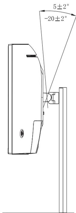
Opmerking: Zorg ervoor dat u bij het aanpassen van de schermhoek de steun van het scherm met één hand vasthoudt en met de andere hand kantelt om te voorkomen dat deze valt.
