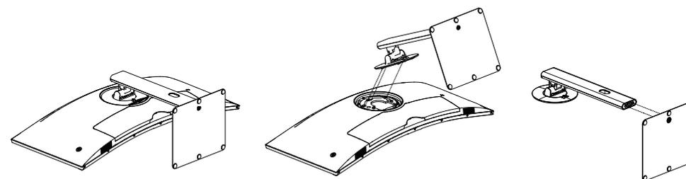
Para retirar el pie, tire hacia arriba el pestillo de bloqueo que se encuentra en la parte trasera de la pantalla y, después, incline la pantalla hacia delante antes de levantarla.
