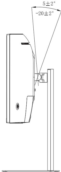
Observación: al ajustar el ángulo de la pantalla, sujete la base de la pantalla con una mano y ajuste la inclinación con la otra para evitar que se caiga la pantalla.
