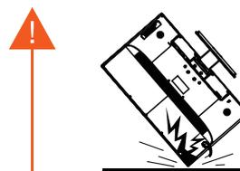
Draai het scherm niet ondersteboven tijdens het installeren van de steun! Dit kan leiden tot beschadiging van het apparaat.
