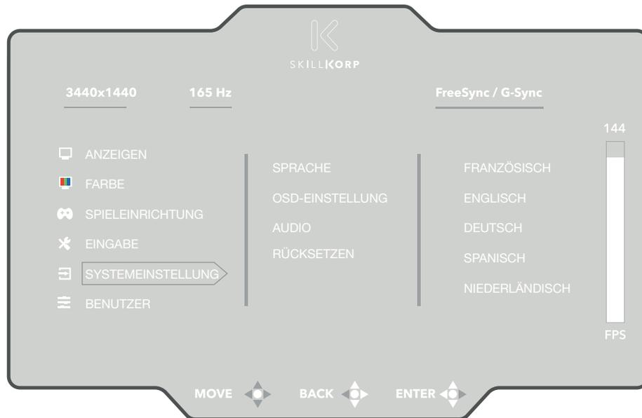
2. Drücken Sie den Bedienknopf nach oben oder nach unten, um in den einzelnen Menüs zu navigieren.
