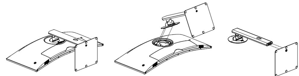
Zum Entfernen des Standfußes ziehen Sie den Verriegelungsschieber auf der Rückseite des Monitors nach oben, neigen den Bildschirm nach vorn und heben ihn dann heraus.
