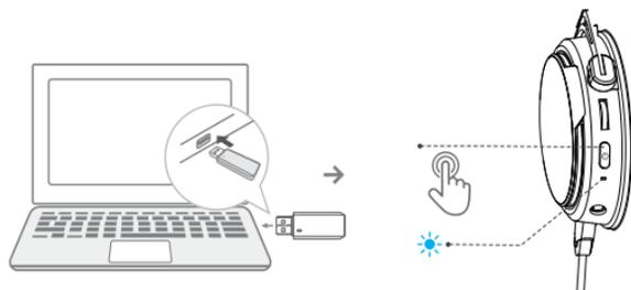
1. Conecte el adaptador inalámbrico a un puerto USB que esté libre en el ordenador. El indicador luminoso del adaptador inalámbrico parpadea en azul, indicando que está esperando una conexión.
