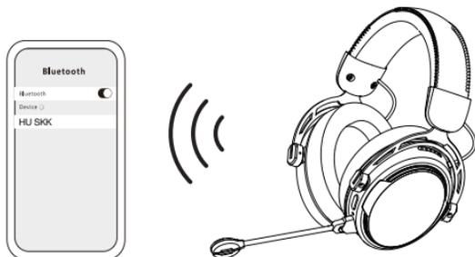
Si dispone de un periférico de audio bluetooth\* (smartphone, tableta, ordenador portátil...), con la conexión inalámbrica puede escuchar música desde su dispositivo de audio sin usar cable. Para usar la función reproducción/pausa, asegúrese de que su dispositivo (teléfono móvil, reproductor de audio, etc.) sea compatible con los perfiles bluetooth\* A2DP y AVRCP.
