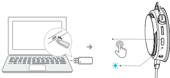
1. Sluit de draadloze adapter aan op een vrije USB-poort van uw computer. Het signaallampje van de draadloze adapter knippert blauw om aan te geven dat hij wacht op verbinding.
