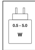
Die Leistung des Ladegeräts muss von einer von der Funkanlage benötigten Mindestleistung von 0.5 Watt bis zu einer zum Erreichen der maximalen Ladegeschwindigkeit benötigten Höchstleistung von 5.0 Watt reichen.
