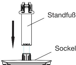
2. Legen Sie den Monitor flach auf eine stabile, ebene Fläche, auf die Sie zuvor ein weiches Tuch gelegt haben und schieben Sie dann den Standfuß in die Aufnahme ein, bis Sie ein „Klick“ hören. Wenn Sie den Standfuß wieder entfernen möchten, drücken Sie auf die Entriegelung und ziehen Sie den Standfuß nach unten heraus.
