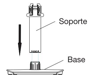
2. Coloque el monitor en plano, sobre una superficie plana y estable cubierta con una tela suave, deslice el pie por la muesca hasta oír un «clic». Si desea quitar el pie, apriete el conector y tire del pie hacia abajo.
