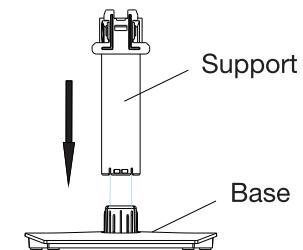
2. Posez le moniteur à plat, sur une surface plane et stable recouverte d'un tissu doux, puis faites glisser le pied dans l'encoche jusqu'à entendre un « clic ». Si vous souhaitez ôter le pied, appuyez sur le détrompeur puis tirez le pied vers le bas.
