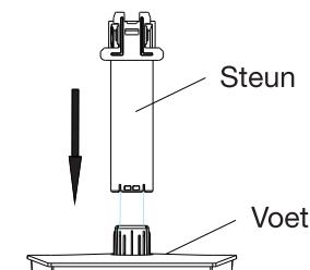
2. Leg het scherm plat neer op een vlakke en stabiele ondergrond bedekt met een zachte stof, en laat de voet in de gleuf glijden totdat u een "klik" hoort. Als u de voet wilt verwijderen, druk dan op het nokje en trek de voet naar beneden.
