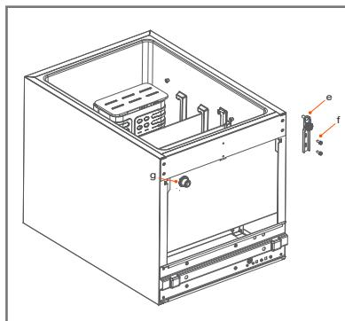
5. Coloque la bisagra inferior (e) en el lado opuesto y enrosque los tornillos (f). A continuación, coloque el pie ajustable (g) del lado opuesto.
