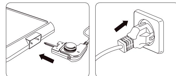
**VOORZICHTIG:** Zorg ervoor dat de temperatuurregelpnop op OFF staat voor u de connector aansluit.
