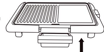
2. Plaats de bak voor het recupereren van sappen en braadvet onder het toestel.
