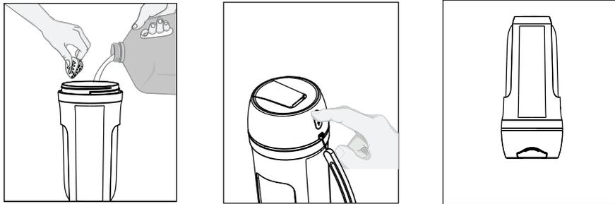
6. Drehen Sie den Becher um und schütteln Sie ihn leicht, um das Mixen zu erleichtern. Das Produkt schaltet sich nach 40 Sekunden automatisch aus. Setzen Sie die 40-Sekunden-Zyklen fort, bis Sie den gewünschten Mischungsgrad erreicht haben. Um den Betrieb vor Ablauf der 40 Sekunden zu stoppen, halten Sie die Ein-/Aus-Taste 3 Sekunden lang gedrückt.
