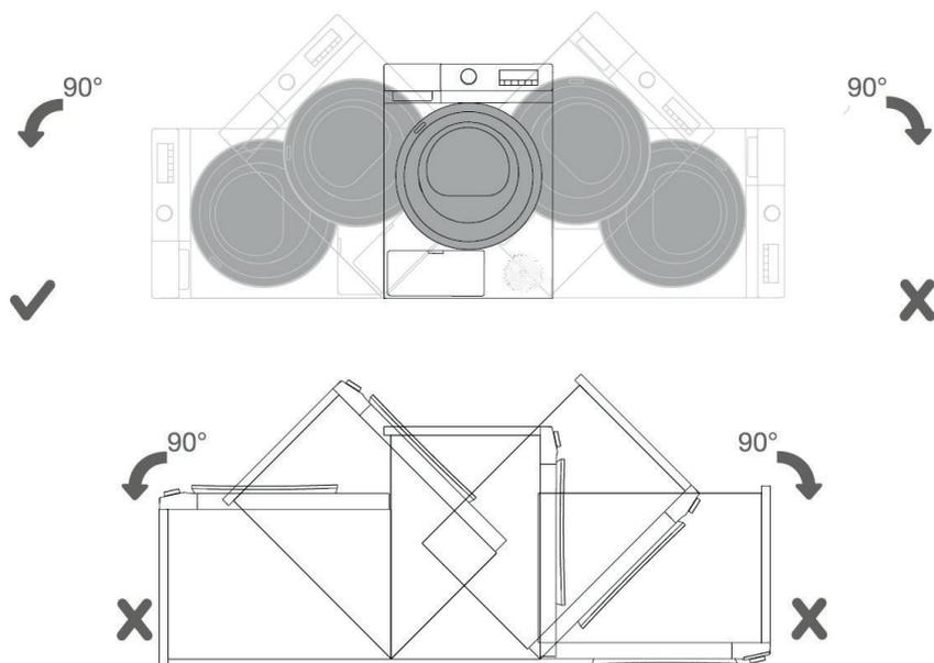
Nous vous recommandons de transporter l'appareil en position verticale. S'il n'est pas possible de le transporter en position verticale, l'appareil doit être transporté en l'inclinant sur la gauche vue de face. Après avoir installé l'appareil à son nouvel emplacement, attendez 24 heures avant de l'utiliser à nouveau.
