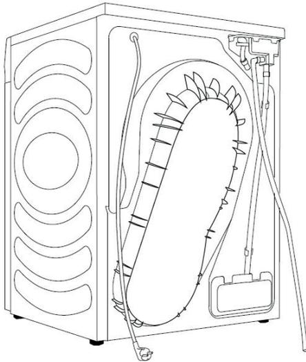
Le tuyau de vidange de l'eau doit être attaché à une hauteur maximum de 80 cm. Veillez à ce que le tuyau de vidange ne soit pas bloqué ou plié entre la vidange et l'appareil.
