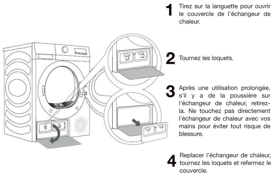
Ne touchez pas les pièces métalliques internes de l'échangeur de chaleur à mains nues. Risque de blessure dûes aux pièces tranchantes. Utilisez des gants de protection appropriés lors du nettoyage de l'échangeur de chaleur.
