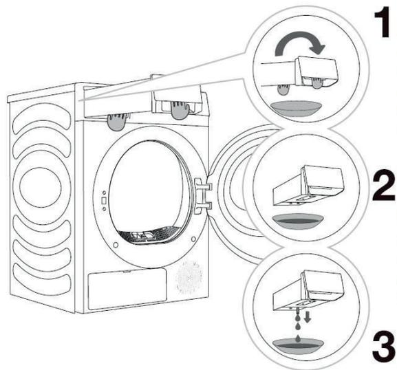
**1** Retirez le bac de récupération de l'eau de condensation. Tirez sur la poignée du réservoir d'une main jusqu'à ce que le réservoir soit à moitié sorti. Puis, soutenez le fond avec votre autre main et continuez à tirer lentement avec les deux mains.
