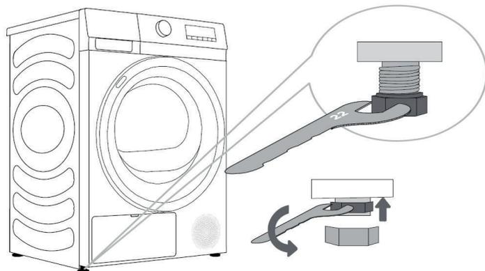
Le sol sur lequel le sèche-linge est installé doit être résistant pour pouvoir supporter le poids de l'appareil. Il doit être propre et sec, sinon le sèche-linge risque de glisser. Nettoyez également les pieds réglables.
