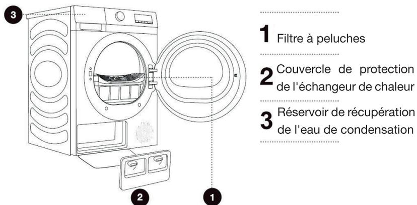
Le sèche-linge ne doit jamais être utilisé sans les filtres en place ou avec des filtres endommagés, car une quantité excessive de fibres accumulées dans le tissu pourrait provoquer un dysfonctionnement ou une panne du sèche-linge.
