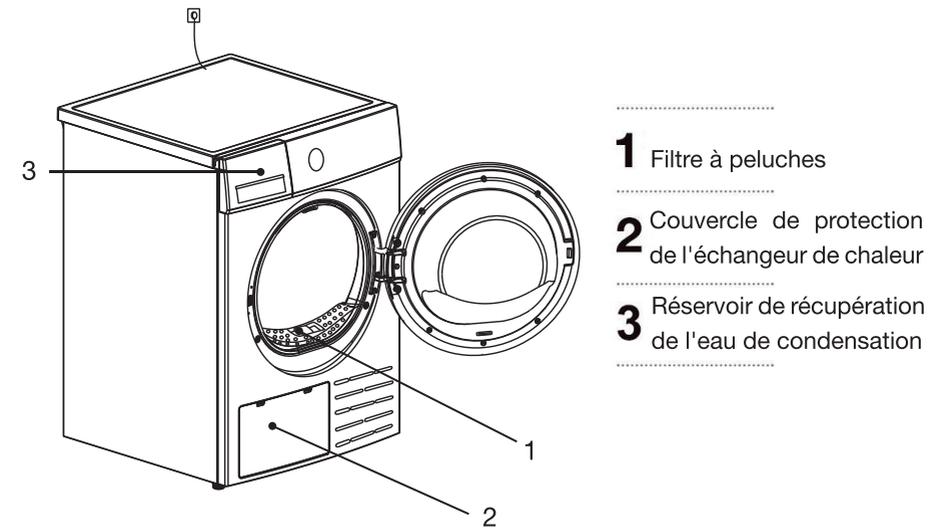
Le sèche-linge ne doit jamais être utilisé sans les filtres en place ou avec des filtres endommagés, car une quantité excessive de fibres accumulées dans le tissu pourrait provoquer un dysfonctionnement ou une panne du sèche-linge.
