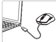
Sluit de muis met de meegeleverde kabel aan op een vrije poort van uw computer. Het besturingssysteem detecteert de muis automatisch.
