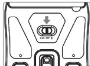
Schieben Sie den Auswahlschalter für den Modus in die Position **OFF**. Die Kontrollleuchte erlischt.
