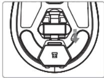
Haal de USB-ontvanger uit het vak en sluit hem aan op een vrije USB-poort van uw computer.
