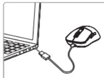
Schließen Sie die Maus mithilfe des mitgelieferten Kabels an einen freien Anschluss Ihres Computers an. Das Betriebssystem erkennt die Maus automatisch.
