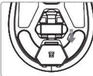
Ziehen Sie den USB-Empfänger aus seinem Fach und schließen Sie ihn an einen freien USB-Anschluss an Ihrem Computer an.
