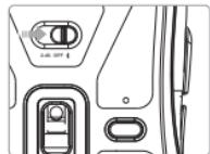
Faites coulisser le bouton de sélection du mode en position
