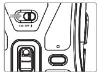
Schieben Sie den Auswahlschalter für den Modus in die Position . Drücken Sie kurz auf die Kopplungstaste, um den Bluetooth-Kanal\* auszuwählen: Die Kontrollleuchte leuchtet grün für den Kanal **BT1** oder blau für den Kanal **BT2**.
