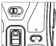
Halten Sie die Kopplungstaste 3 Sekunden lang gedrückt. Die Kontrollleuchte blinkt schnell.
