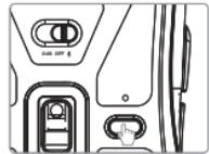
Halten Sie die Kopplungstaste 3 Sekunden lang gedrückt. Die Kontrollleuchte blinkt schnell.
