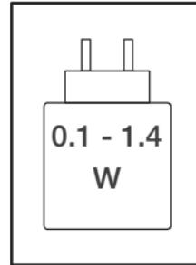
La puissance fournie par le chargeur doit être entre, au minimum, 0.1 Watts requis par l'équipement radioélectrique et, au maximum, 1.4 Watts pour atteindre la vitesse de chargement maximale.
