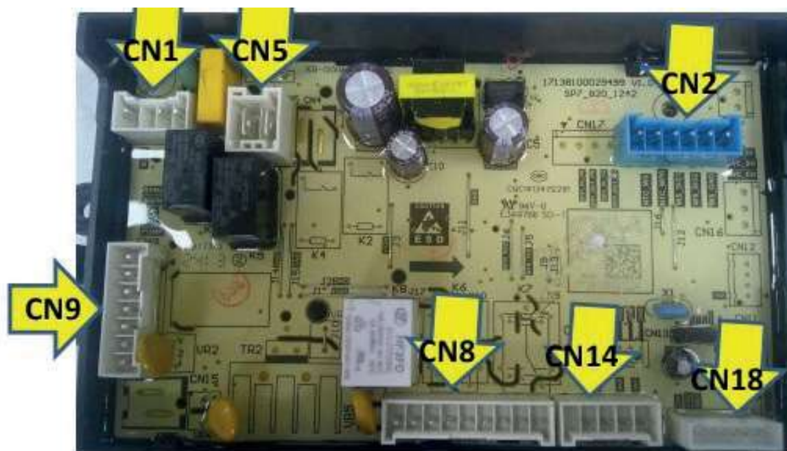
Connecteurs carte principale / Main board connectors
