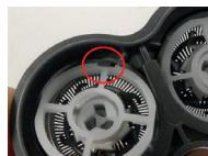
Es ist darauf zu achten, dass die Kerben des Kunststoffrings über den Keilen der abnehmbaren Lagerung liegen und beide Seiten fest eingerastet sind.
