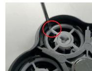
Om de koppen schoon te maken, begint u met het los klikken van de plastic ring met een schroevendraaier, waarbij u druk uit oefent tussen het platte gedeelte en de kophouder.
