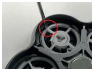
Pour le nettoyage des têtes, commencez par déclipser le cercle en plastique à l'aide d'un tournevis en faisant une pression entre le méplat et le support de la tête.
