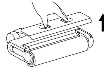
2. Richten Sie die Abdeckung der Bürstenwalze an der Bodenbürste aus und drücken Sie sie nach unten. Die Abdeckung der Bürstenwalze ist korrekt eingerastet, wenn ein Klicken zu hören ist.
