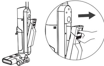
6. Plaats eerst de onderkant van het schoonwaterreservoir op de steun in de uitsparing aan de achterkant van de reiniger en duw het reservoir voorzichtig in de uitsparing totdat u een klik hoort, wat aangeeft dat het correct is geïnstalleerd.
