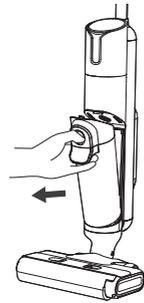
2. Halten Sie den Tank mit einer Hand fest und heben Sie mit der anderen den Schmutzwassertank heraus.
