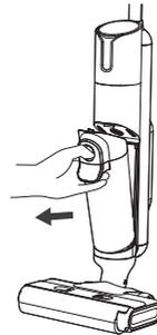
2. Houd het reservoir met één hand vast en til het vuilwaterreservoir met de andere hand omhoog om het te verwijderen.
