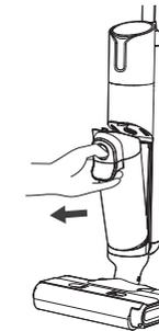
2. Tenez le réservoir d'une main et, de l'autre, sortez le réservoir d'eau sale en le soulevant.
