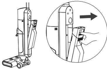
6. Setzen Sie zunächst den unteren Teil des Frischwassertanks in seine Halterung in dem Gehäuse an der Rückseite des Reinigers ein und schieben Sie den Tank vorsichtig in das Gehäuse, bis Sie ein Klicken hören, das signalisiert, dass er korrekt eingesetzt ist.
