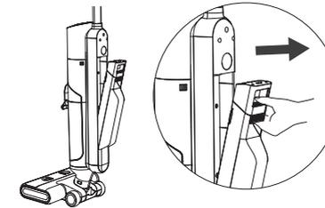
6. Insérez d'abord le bas du réservoir d'eau propre sur son support dans le logement à l'arrière du nettoyeur et poussez délicatement le réservoir dans le logement jusqu'à entendre un clic qui indique qu'il est correctement installé.
